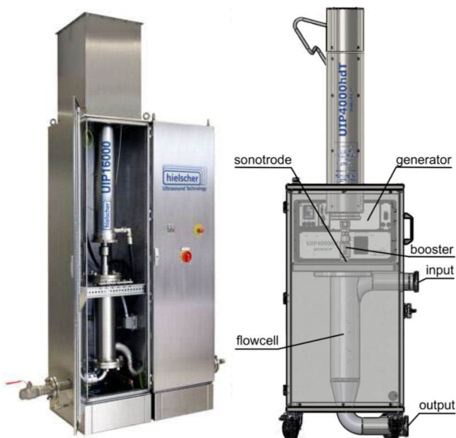
Рис.10. Установки ультразвукової обробки молочної продукції: а) промисловий ультразвуковий гомогенізатор UIP16000 для внутрішньої пастеризації харчових продуктів і напоїв; б) ультразвукова установка UIP4000HDT для нетермічної внутрішньої пастеризації харчових продуктів (наприклад, молочних продуктів, молока, соків, рідких яєць, напоїв) [13]
