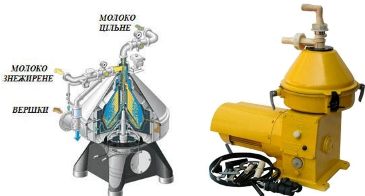
Рис.2. Сепаратор ОМ-1А: а) схема сепаратора; б) загальний вигляд [5]
