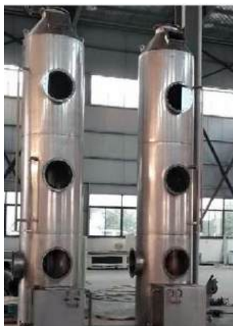
1 – корпус краплеуловлювача; 2 – турбулізатор; 3 – корпус скрубєрної частини апарату Рисунок 7.19 – Модифікація порожнистого скрубєра
