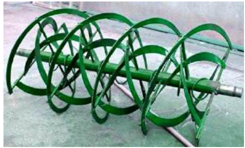
1 – радіальна траверса; 2 – втулка; 3 – вал; 4 та 5 – спіральні стрічки
