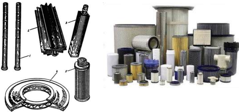
1 – циліндричні зварні; 2 – «зірочка»; 3 – коробчастий; 4 – сочевицеподібний; 5 – гофрований Рисунок 7.33 – Фільтрувальні елементи і картриджі з пористих матеріалів
