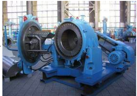
1 – розвантажувальний бункер; 2 – живильна труба; 3 – механізм зрізання осаду; 4 – кожух; 5 – ротор; 6 – опори валу; 7 – вал; 8 – станина
