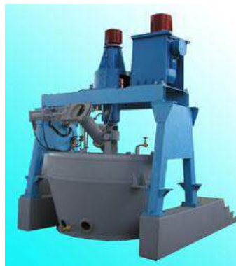
1 – ротор; 2 – стійки; 3 – вал; 4 – привід; 5 – опора приводу; 6 – кожух
