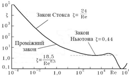
Рисунок 6.2 – Залежність коефіцієнта опору \zeta рідини від критерію Re для руху частинок сферичної форми в рідині
