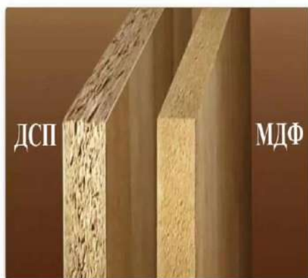
Рис. 32 – Порівняння структури МДФ та ДСП
