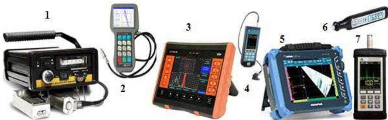
Рис. 60 – Дефектоскопи: 1 – імпульсний імпедансний ІД-92НМ, 2 – вихореструмний ВДЗ-71, 3 – акустичний АД-60К, 4 – мініатюрний ультразвуковий А1211 MINI, 5 – ультразвуковий OMNISCAN SX; Товщиноміри: 6 – ультразвуковий А1207, 7 – електромагнітно-акустичний А1270
