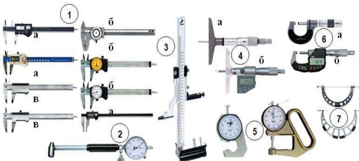
Рис. 36 – Прилади для вимірювання: 1 – штангенциркуль: а – цифровий, б – циферблатний, в – ноніусний; 2 – нутромір; 3 – штангенрейсмус (штангенвисотомір); 4 – глибиномір: а – цифровий; б – електронний; 5 – товщино метр; 6 – мікрометр: а – цифровий, б – електронний; 7 – скоби
