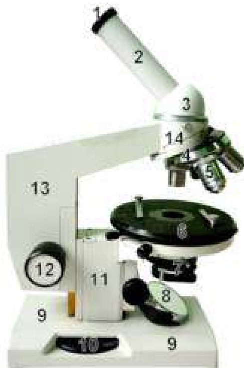
Рис. 5. 1. Мікроскоп МІКМЕД–1: 1 – окуляр; 2 – тубус; 3 – футляр призми; 4 – револьвер; 5 – об’єктив; 6 – предметний столик; 7 – конденсор, діафрагма, світлофільтр; 8 – дзеркало; 9 – підставка штатива; 10 – мікрогвинт; 11 – коробка механізму точного фокусування; 12 – макрогвинт; 13 – тубусоутримувач (колонка); 14 – головка тубусоутримувача
