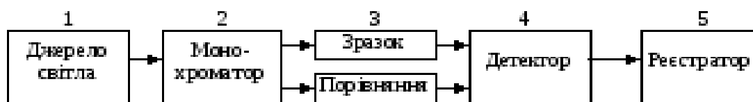
Рисунок 6.7 – Принципова схема молекулярно-абсорбційного приладу
