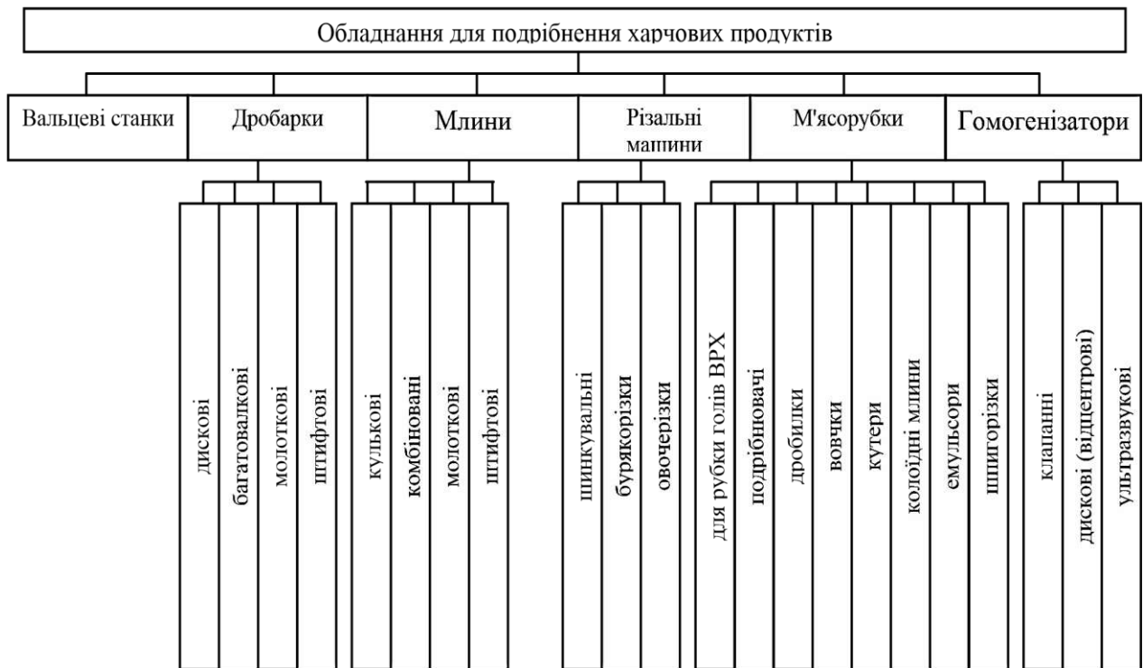
Рис. 2.1.3 – Класифікація устаткування для подрібнення харчової сировини.
