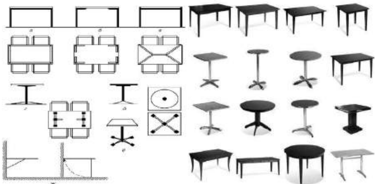
Рис. 185. Основні конструктивні прийоми рішення обідніх столів: а-в – чотирихопорні; – двохопорні; д-е – одноопорні; ж – р консольні
