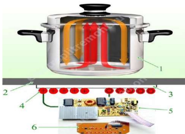
Рисунок 6.3 – Електроконтактне нагрівання: 1 – посуд; 2 – настил; 3–6 – електричний пристрій
