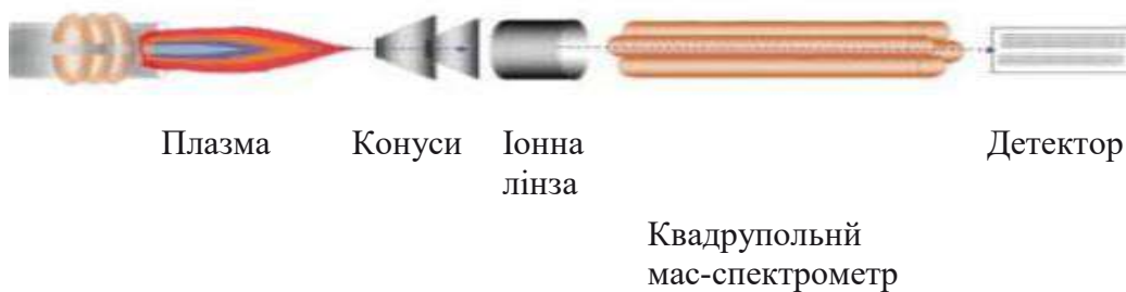
Рис. 3.5. Схема класичної ІСП-МС системи
