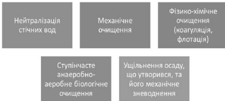
Рис. 8.2. Схема очищення стічних вод до норм водоканалів (рис. автора)
