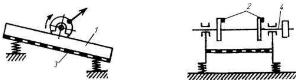
1 – корпус; 2 – дебаланси; 3 – сито; 4 – вал
