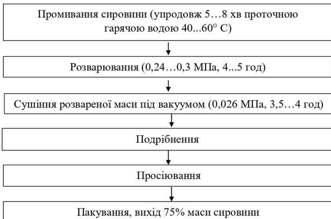
Рисунок 1.12 – Технологічний процес виробництва рого-копитного кормового борошна
