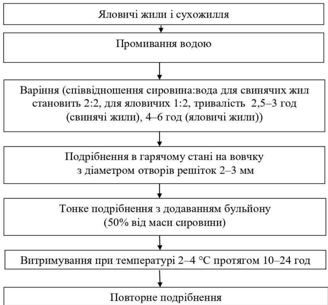
Рисунок 2.14 – Технологія виробництва білкового препарату зі свинячих і яловичих жил, сухожиль (вихід 120%)
