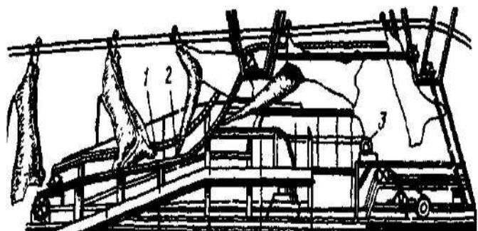
Рисунок 1.3 – Установка для знімання шкір із туш ВРХ РЗ-ФУВ: 1 – конвеєр для кінцівок; 2 – конвеєр для знімання шкіри; 3 – конвеєр для транспортування шкір
