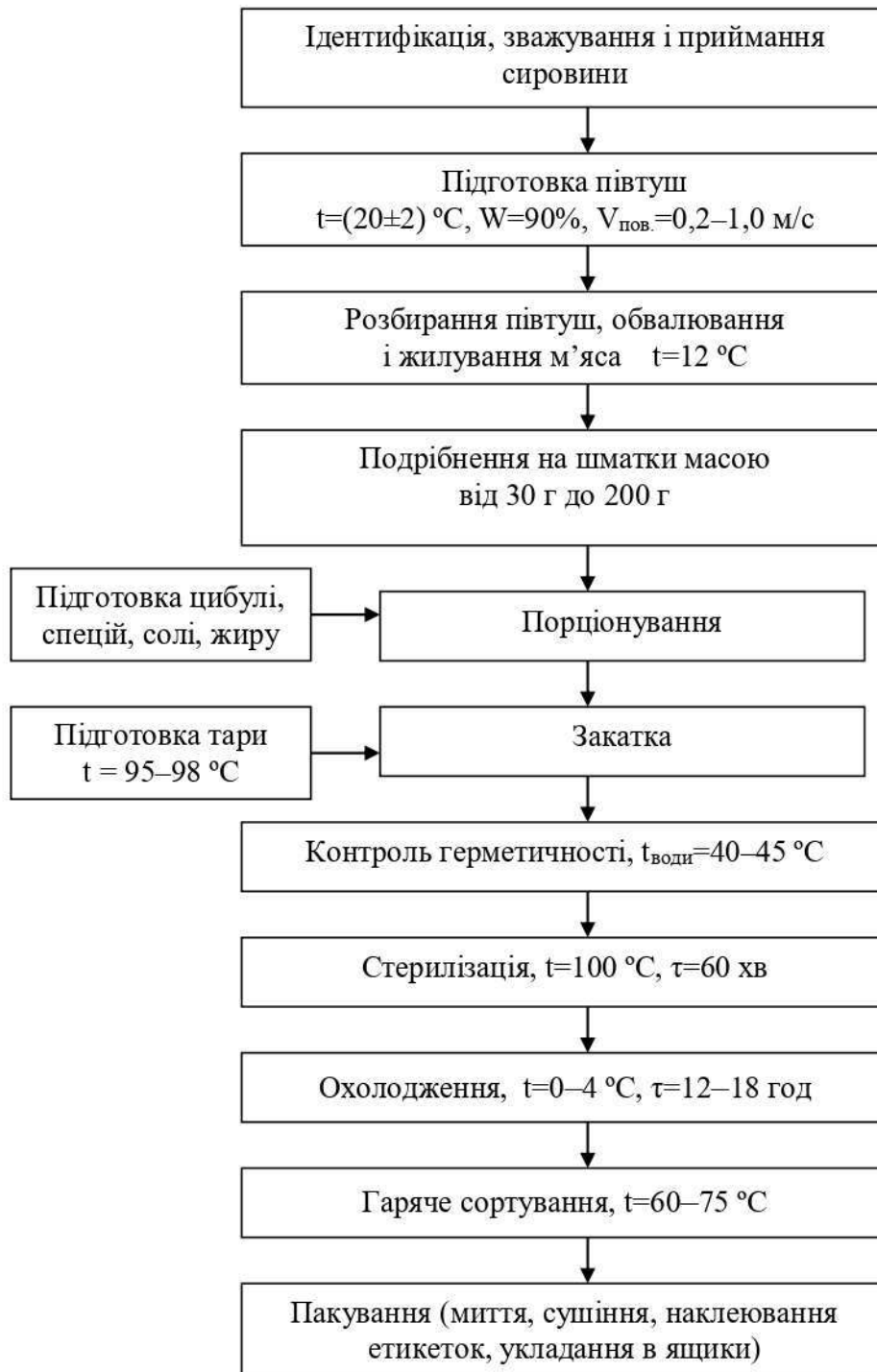
Рисунок 2.34 – Технологічна схема виробництва консервів натуральних
