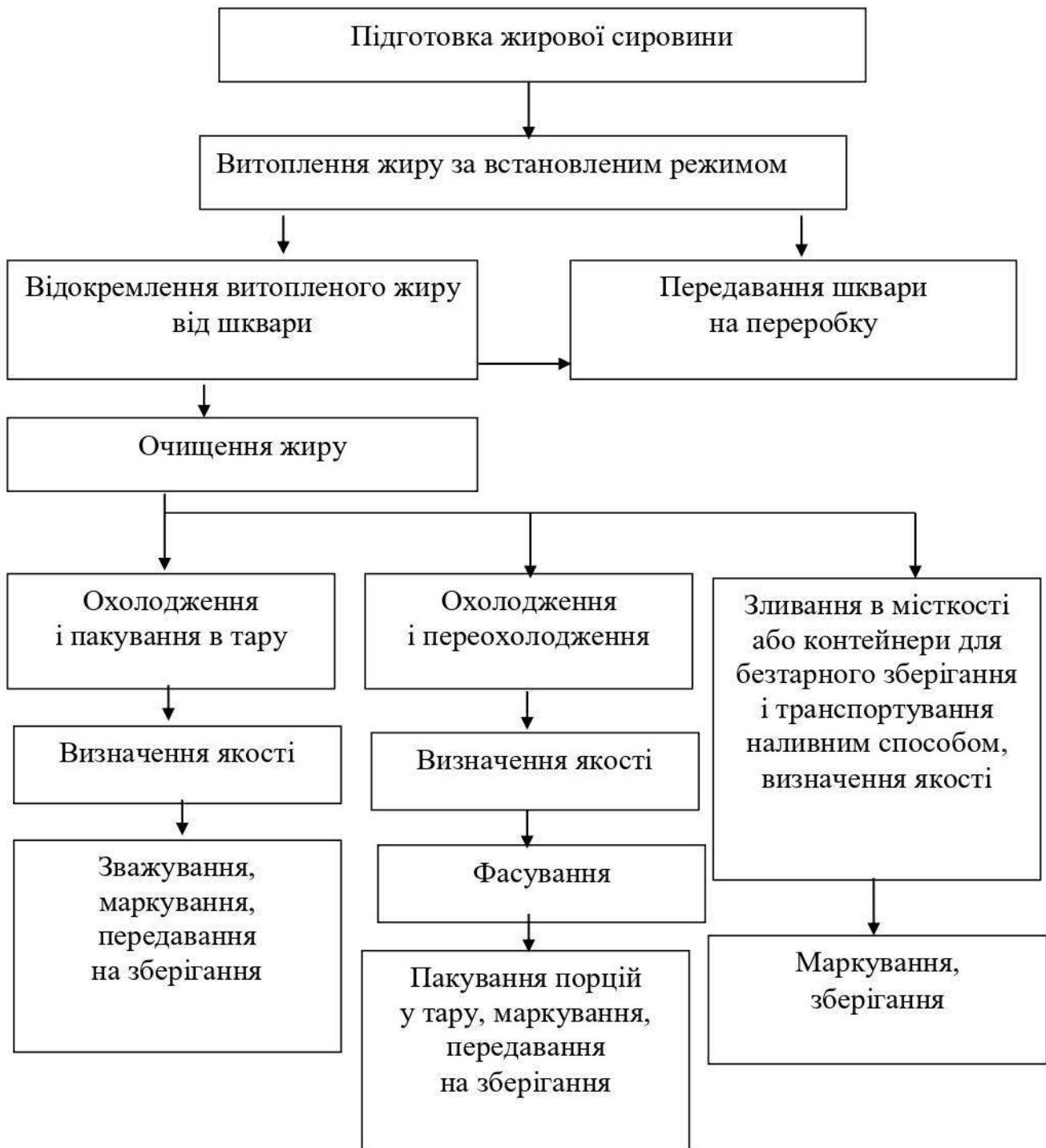
Рисунок 1.9 – Технологічна схема виробництва тваринних жирів
