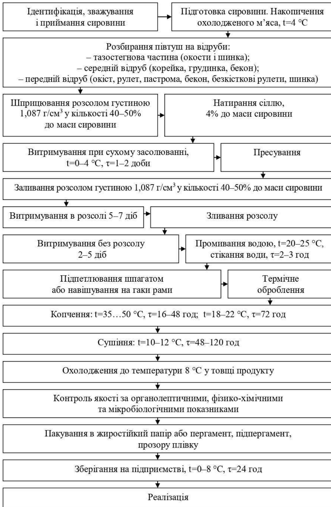
Рисунок 2.33 – Технологічна схема виробництва сирокопчених виробів зі свинини
