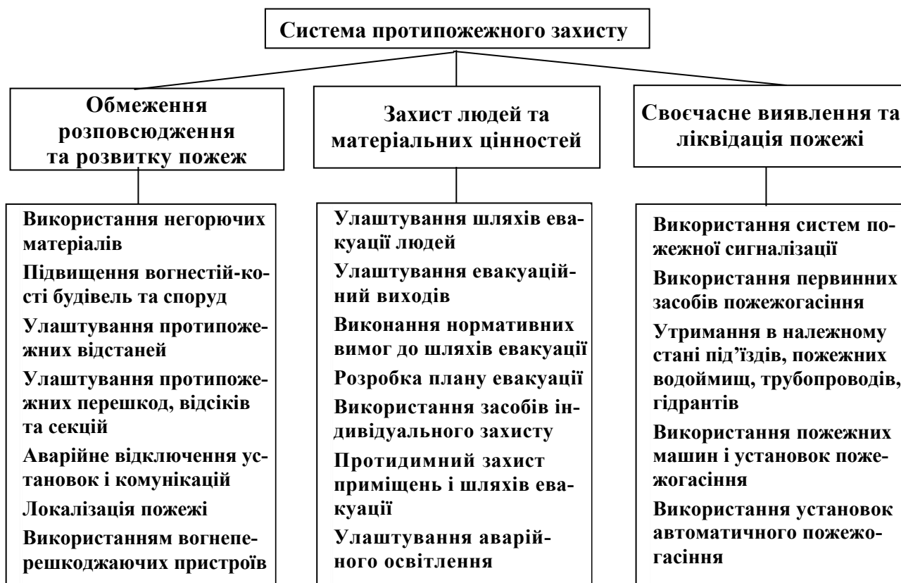
Рис. 3.26. Структура системи протипожежного захисту
