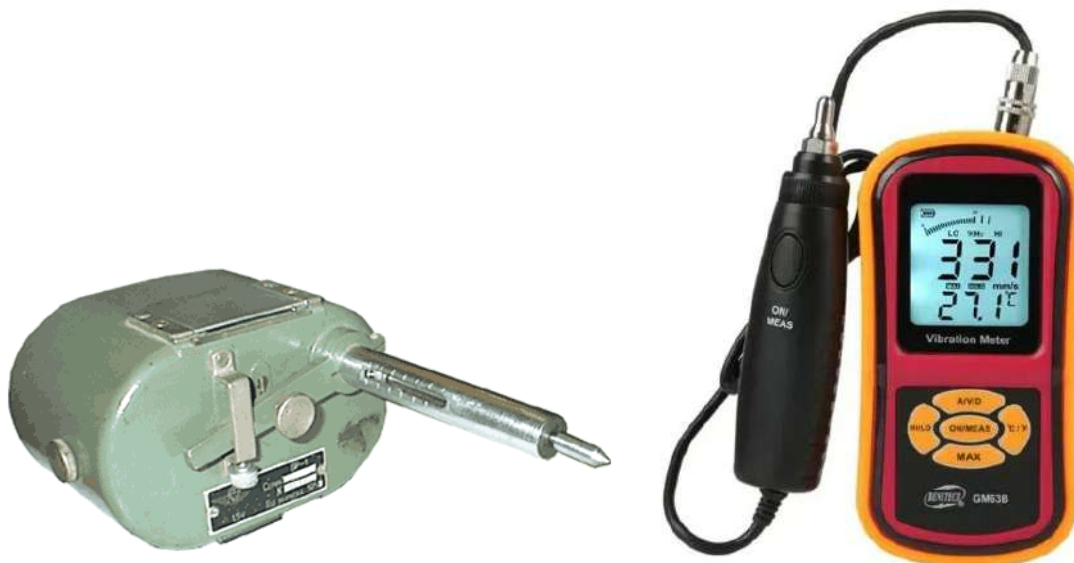
Рис. 2.30. Вигляд вібрографа ручного ВР-1 та вимірювача вібрації BENETECH GM63B
