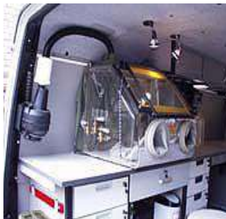
Рис. 2.37. Засоби захисту від дії іонізуючого випромінювання: а – контейнер для зберігання радіоактивних речовин; б – бокс, оснащений спеціальним маніпулятором; в – витяжна шафа
