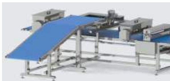
Рис. 19. Устаткування для ламінування листового тіста
