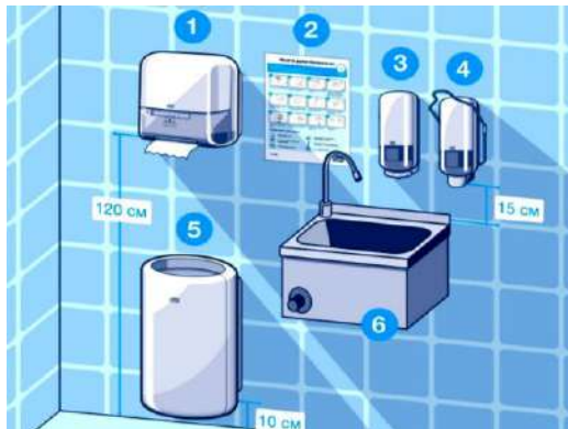
Рисунок 8 – Рекомендована схема облаштування рукомийника
