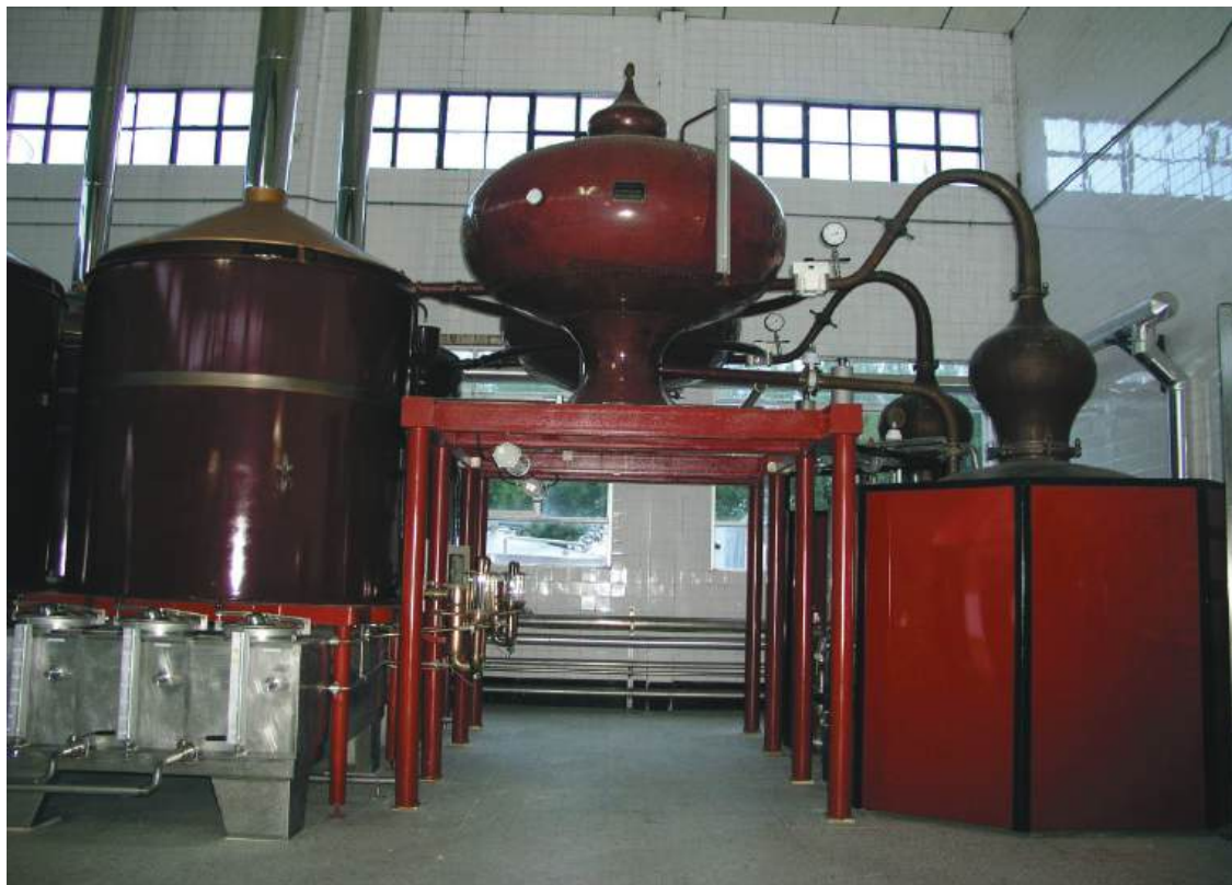
Рис. 9.1. Дистиляційна установка шарантського типу
