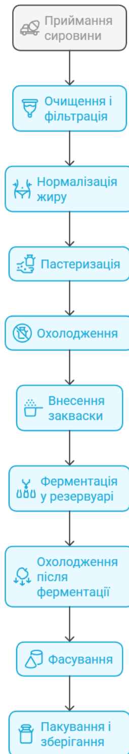
Рис. 2.1 Горизонтальна декомпозиція технологічної системи виробництва сметани
