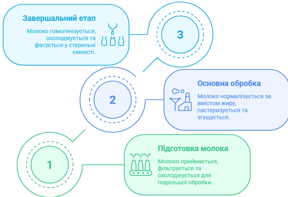
Рис. 2.2 Ієрархічна декомпозиція технологічної схеми (на прикладі виробництва згущеного молока)
