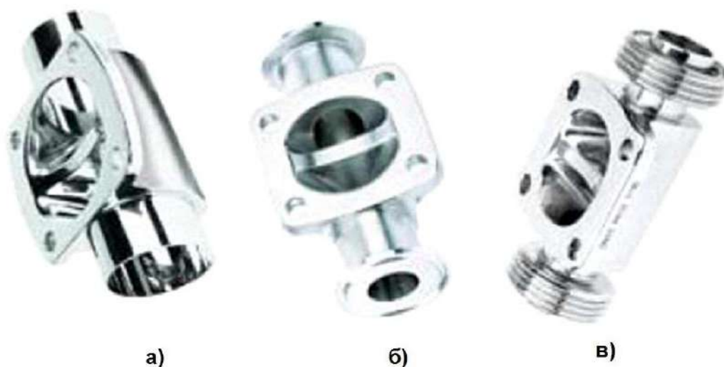
Рис.6.12. Типи з'єднань корпусу асептичного мембранного крану-клапану Saunders з трубопроводами: а) зварне; б) за допомогою хомута Clamp; в) різьбове за допомогою накидної гайки.
