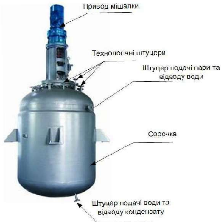
Рис.7.9. Загальний вигляд реактора для стерилізації компонентів ПС з мішалкою та сорочкою
