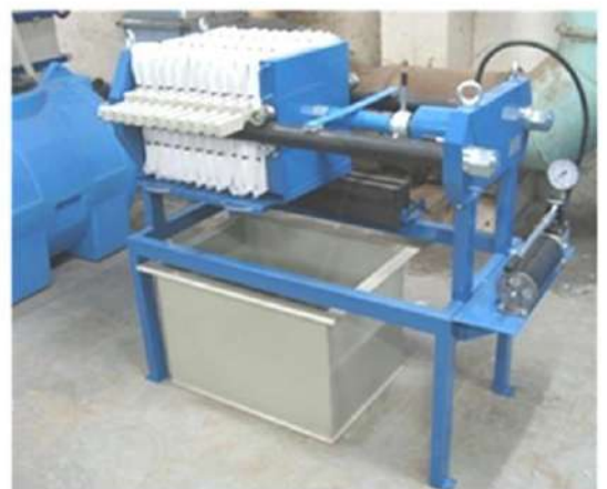
Рис.8.10. Схема роботи та загальний вигляд рамного фільтр-преса періодичної дії: \Delta P > P_{\text{атм}}
