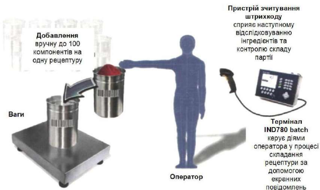
Рис.7.17. Приклад встановлення ручної системи дозування декількох компонентів фірми Mettler Toledo AG
