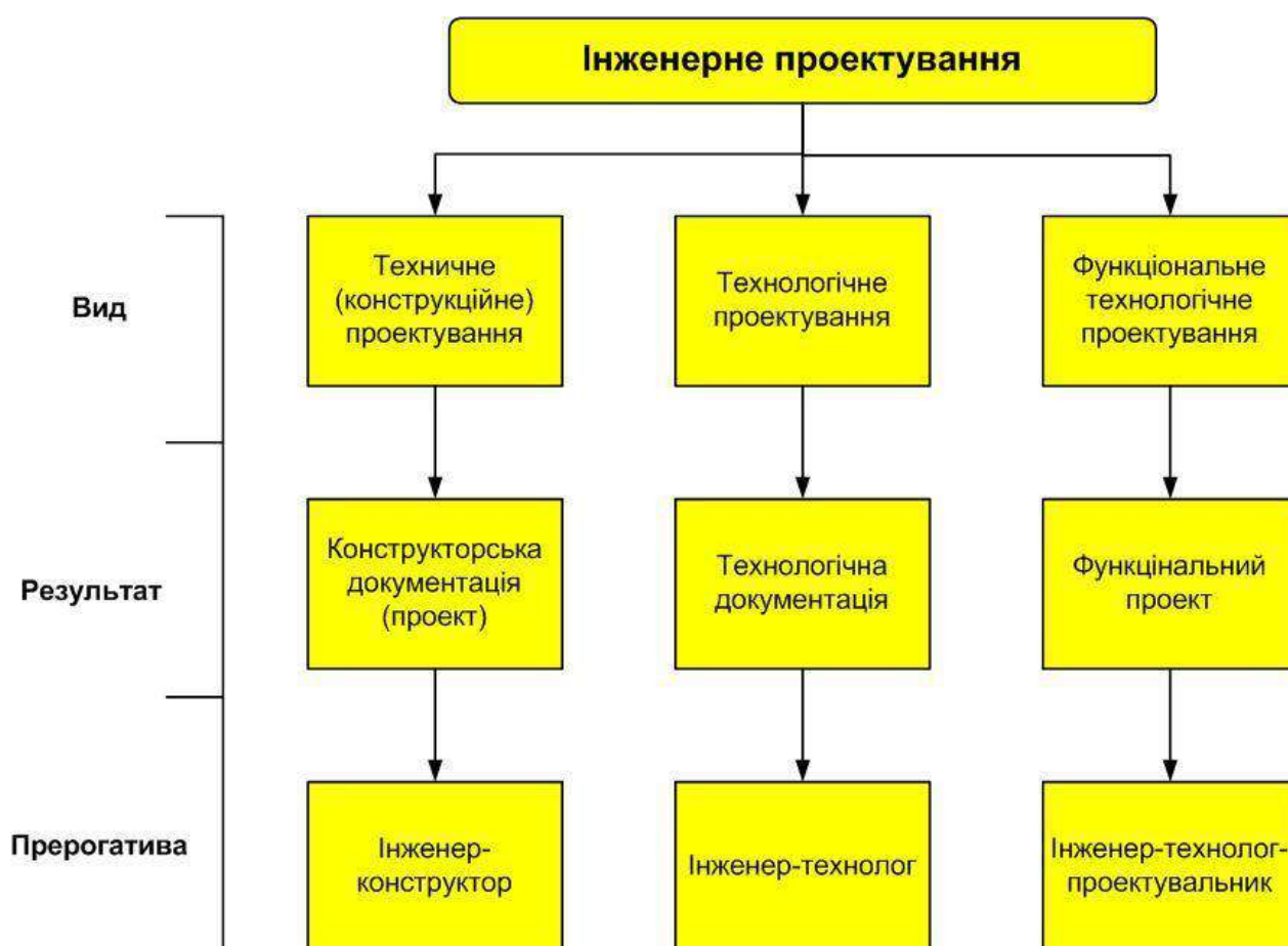
Рис.1.1. Структура інженерного проєктування
