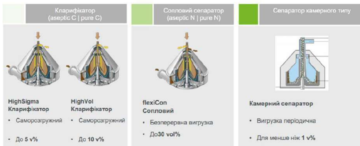
Рис.8.22. Мультимодульна система сепарування з різними типами барабанів
