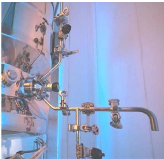
Рис.6.29. Приклад практичної реалізації схеми відкритого відбору вентилями-клапанами Saunders та швидкоз'ємними затискувачами типу Clamp
