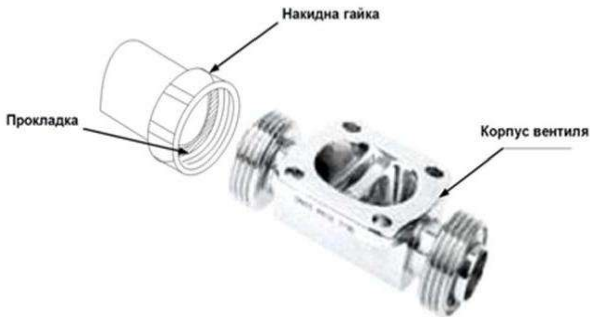
Рис. 6.26. Конструкція різьбового з'єднання за допомогою накладної гайки
