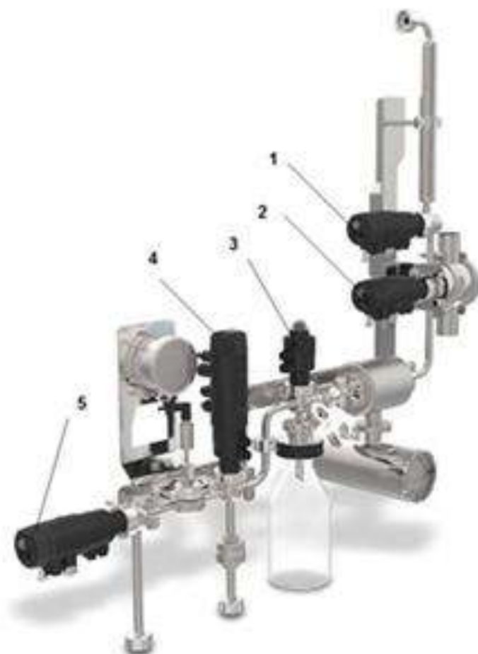
Рис.6.31. Схема промислового закритого пристрою для відбору проб: 1 – впускний клапан пари; 2 – пробовідбірний клапан Vesta ®; 3 – впускний клапан пляшки (колби); 4 – вихідний клапан з паровим захистом; 5 – регулюючий вихідний клапан
