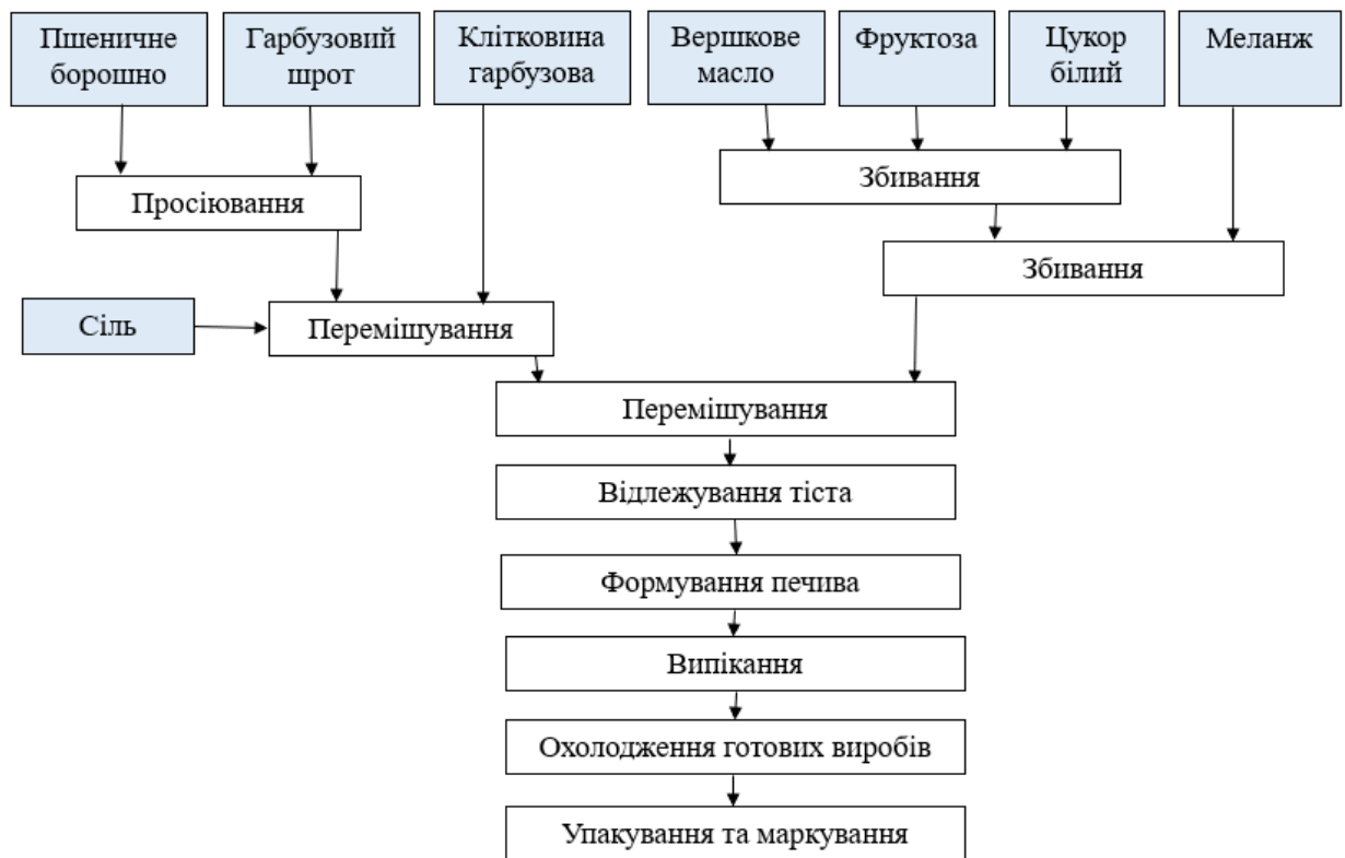
Рисунок 2.3 – Технологічна схема приготування пісочного печива «Осінній дотик»
