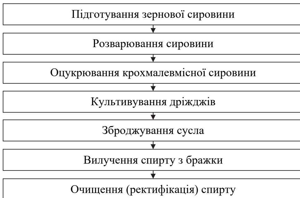
Рис. 8.1. Принципова технологічна схема виробництва спирту з крохмалевмісної сировини
