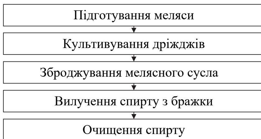
Рис. 8.5. Принципова технологічна схема виробництва спирту з меляси
