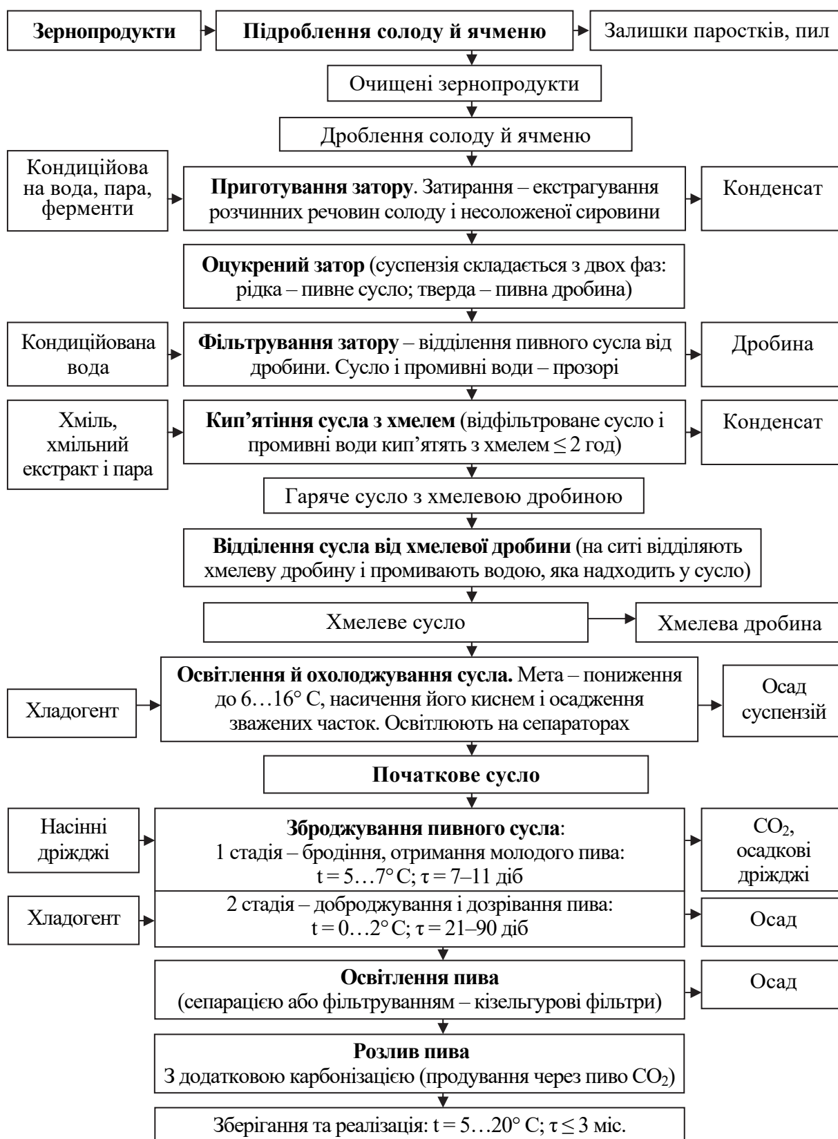
Рис. 7.7. Принципова схема виробництва пива
