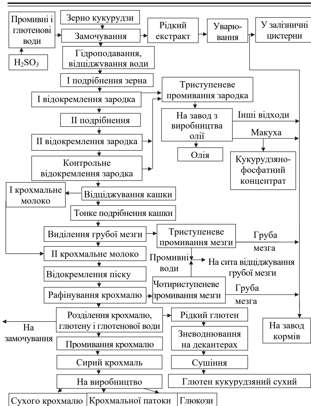
Рис. 11.3. Принципова технологічна схема виробництва кукурудзяного крохмалю
