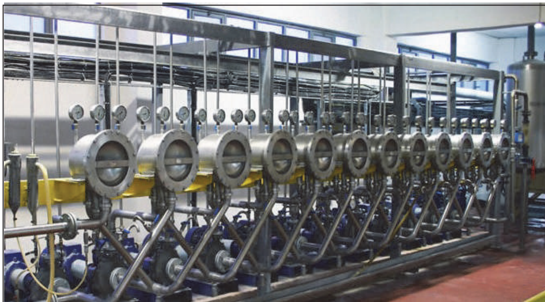
Рис. 11.4. Гідроциклонна установка для промивання крохмалю від глютену
