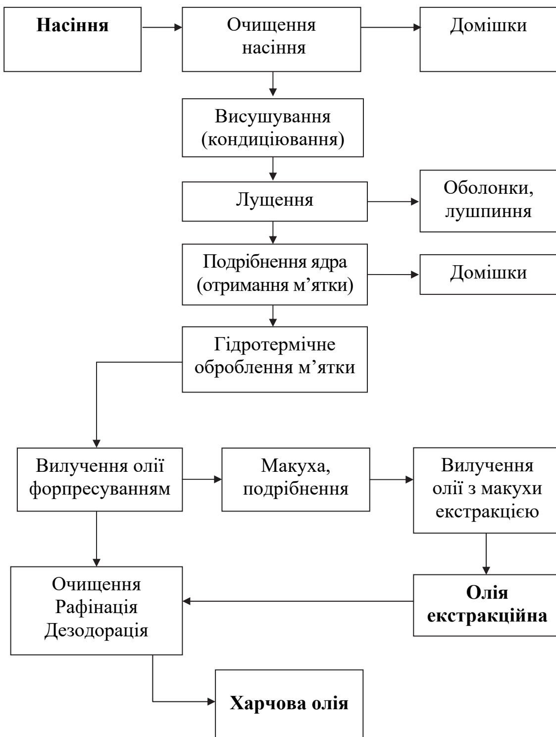
Рис. 1.1. Принципова технологічна схема виробництва олії
