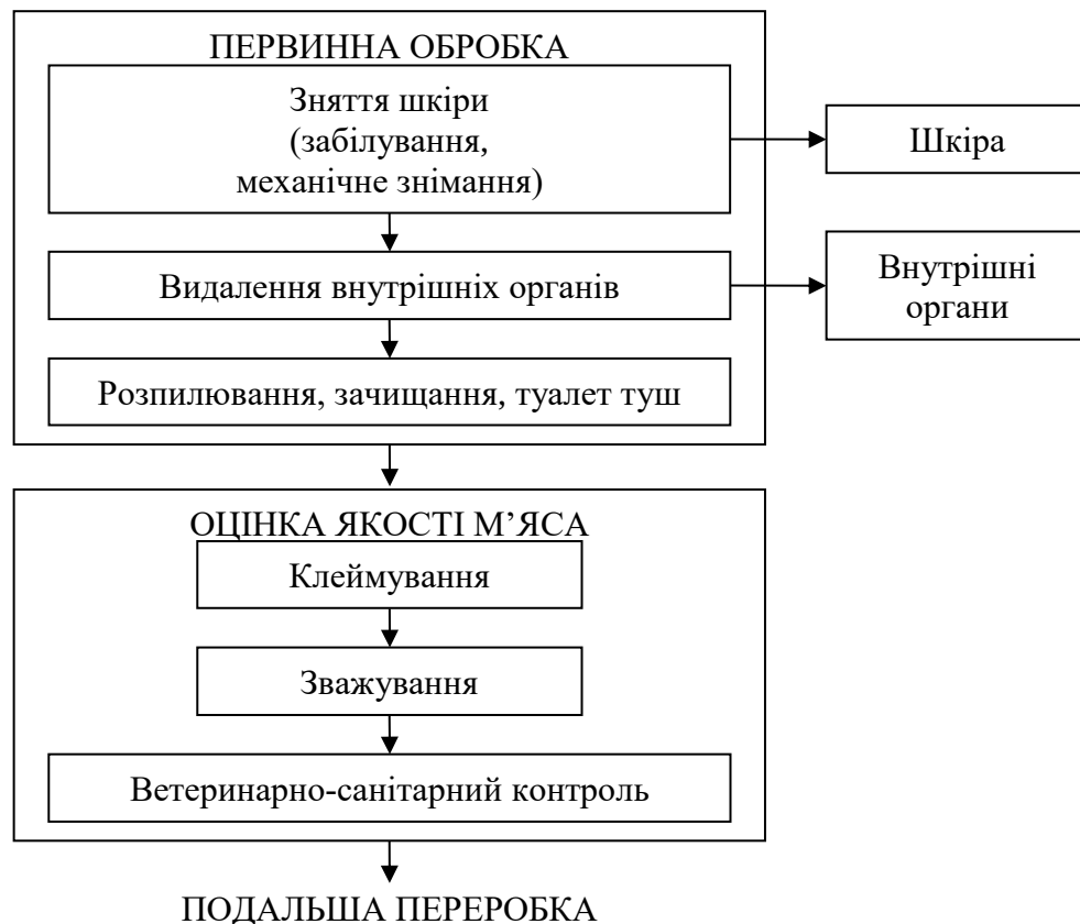
Рисунок 1.7 – Принципова схема первинної переробки туш забійних тварин
