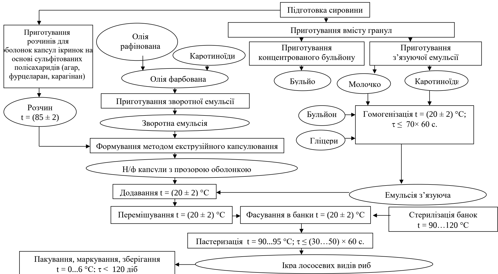
Рисунок 4.26 – Технологічна схема виробництва аналога ікри лососевих видів риб (імітованої)
