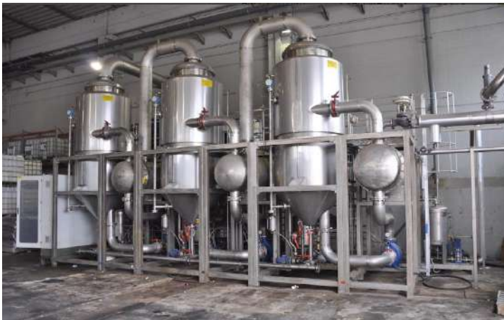
1, 2, 3 – корпуси; 4 – підігрівач; 5 – барометричний конденсатор; 6 – пастка бризко-уловлювач; 7 – вакуум-насос
