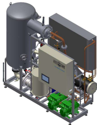
1 – випарний апарат; 2 – струменевий компресор (інжектор)
