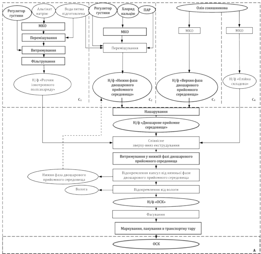
Рисунок 1.60 – Принципова технологічна схема виробництва олії соняшникової капсульованої
