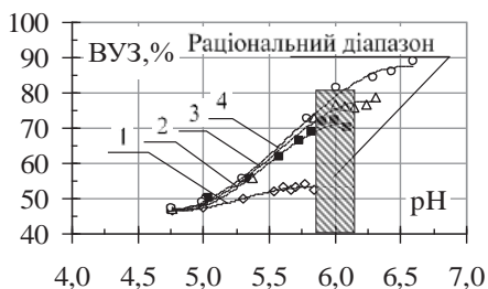
Рисунок 6.5 – Залежність ВУЗ білкової основи від активної кислотності за концентрації натрію двовуглекислого 1 – 0,3 %; 2 – 0,4 %; 3 – 0,5 %; 4 – 0,6 %
