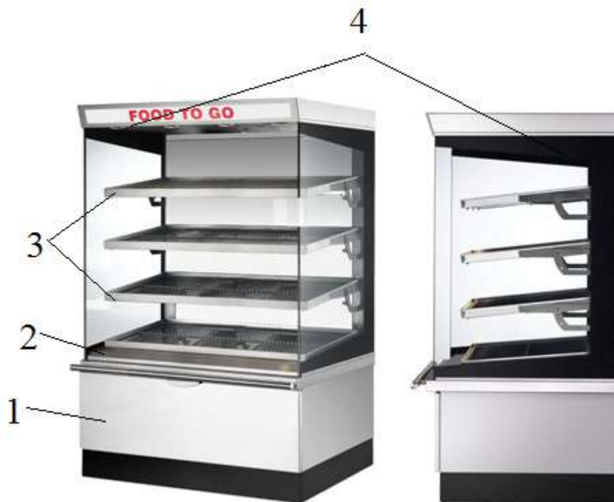
Рис. 105 – Принципова схема теплової вітрини: 1 – рамний каркас; 2 – стіл; 3 – полиці; 4 – нагрівальні елементи
