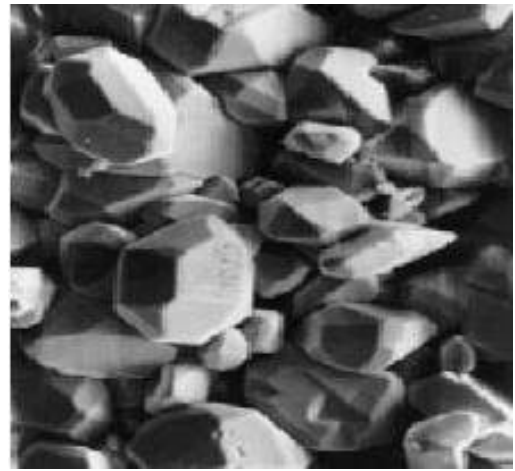
Рис. 8.10. Грати свинцевого акумулятора а – зовнішній вигляд сульфатації; б – мікрофотографія кристалів PbSO 4
