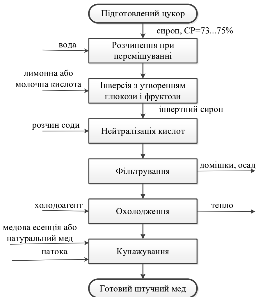
Рис. 15.9. Принципово-технологічна схема отримання штучного меду
