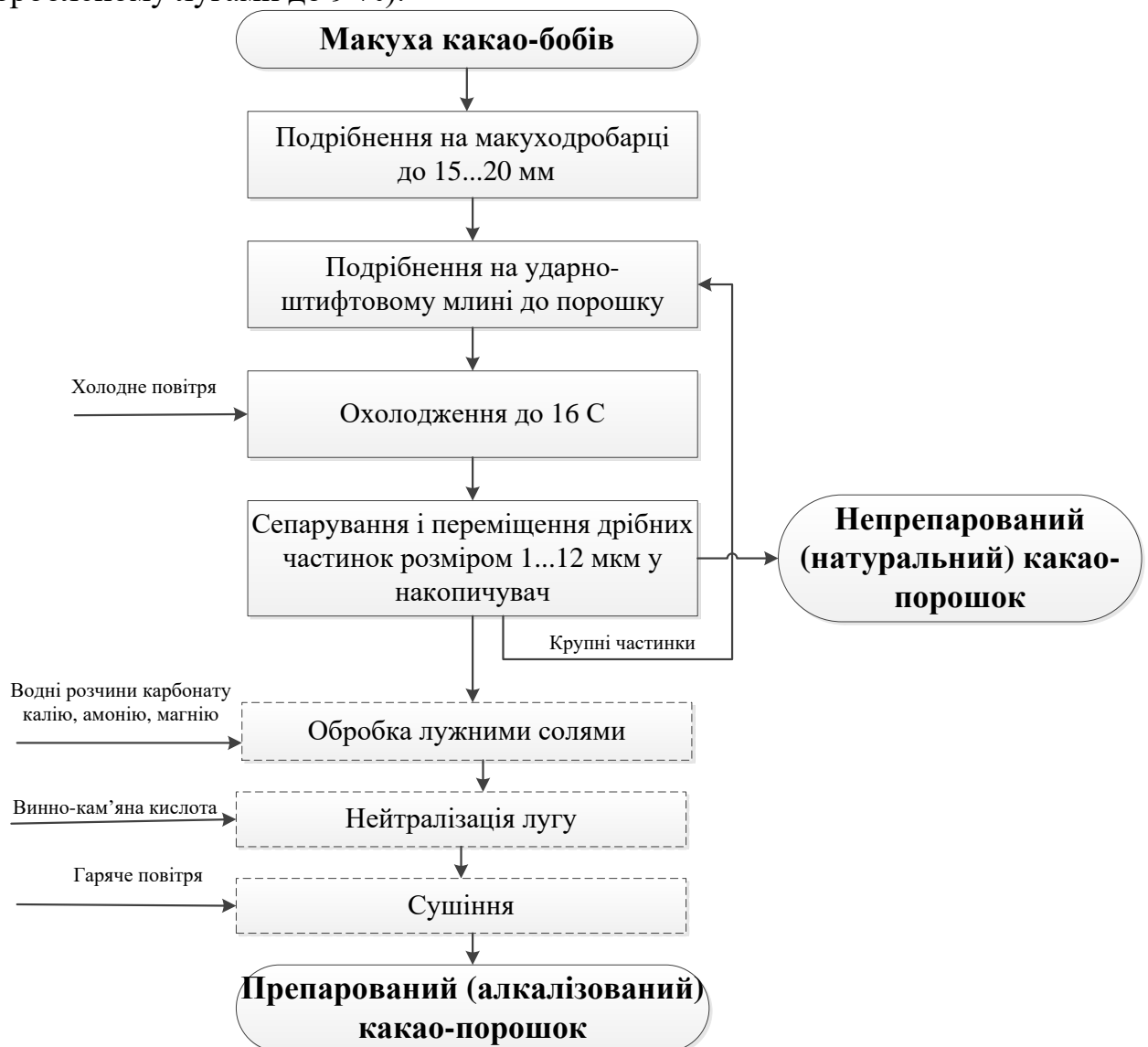
Рис. 8.3. Принципово-технологічна схема виробництва какао-порошку
