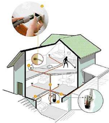
Рисунок - Схема влаштування мереж центрального пирососа
