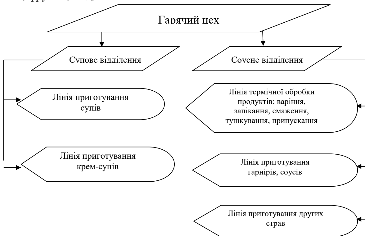
Рисунок - Структурно-технологічна схема гарячого цеху ресторану
