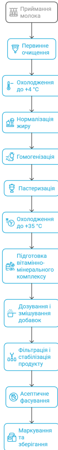
Рис. 2.1 Горизонтальна декомпозиція технологічної системи виробництва збагаченого питного молока
