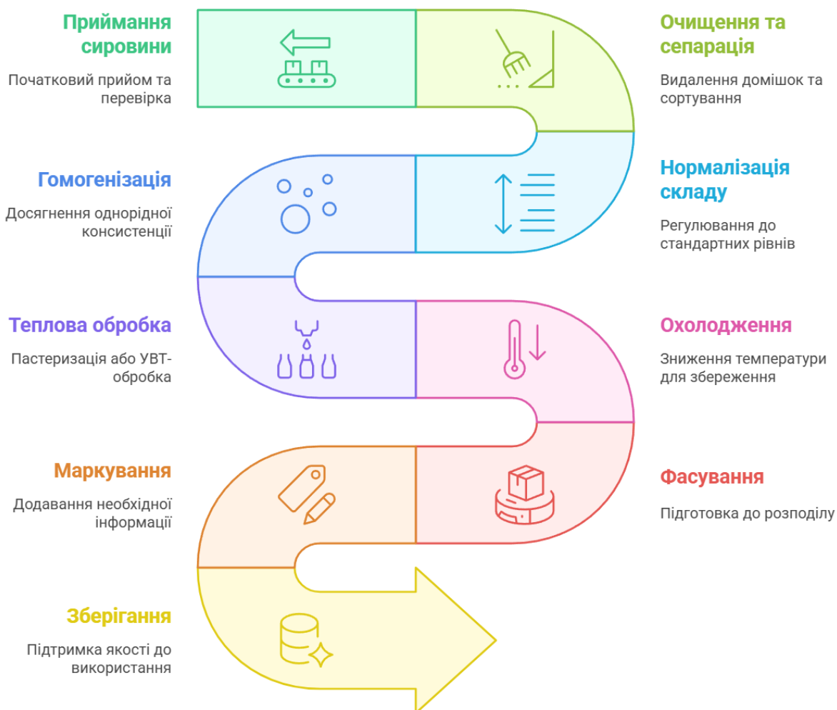
Рис. 2.1 Горизонтальна схема технологічного процесу виробництва та зберігання питного молока
