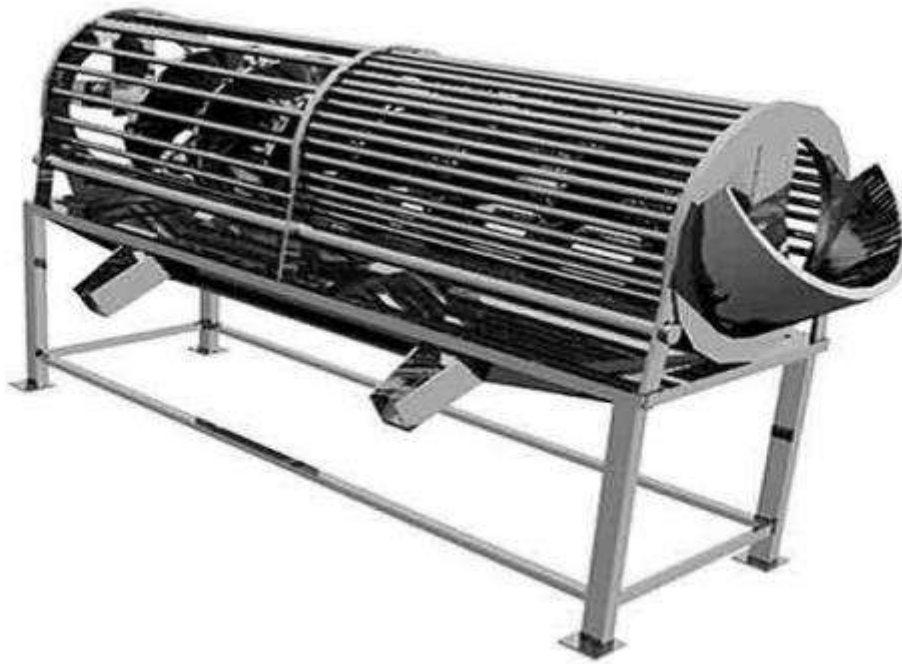
Рис. 1. Загальний вигляд барабанної калібрувальної машини
