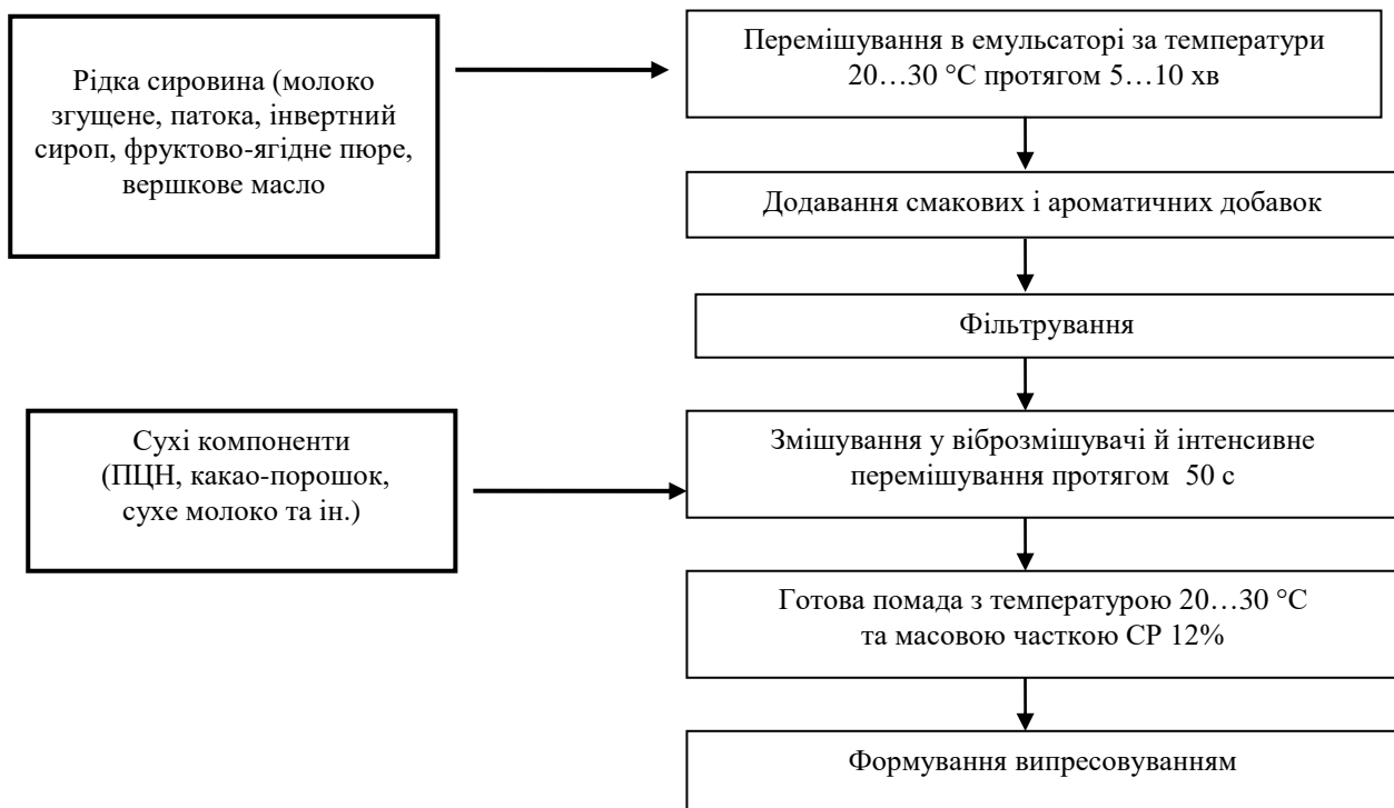
Рис. 4.2. Технологічна схема виготовлення помадних мас «холодним способом»
