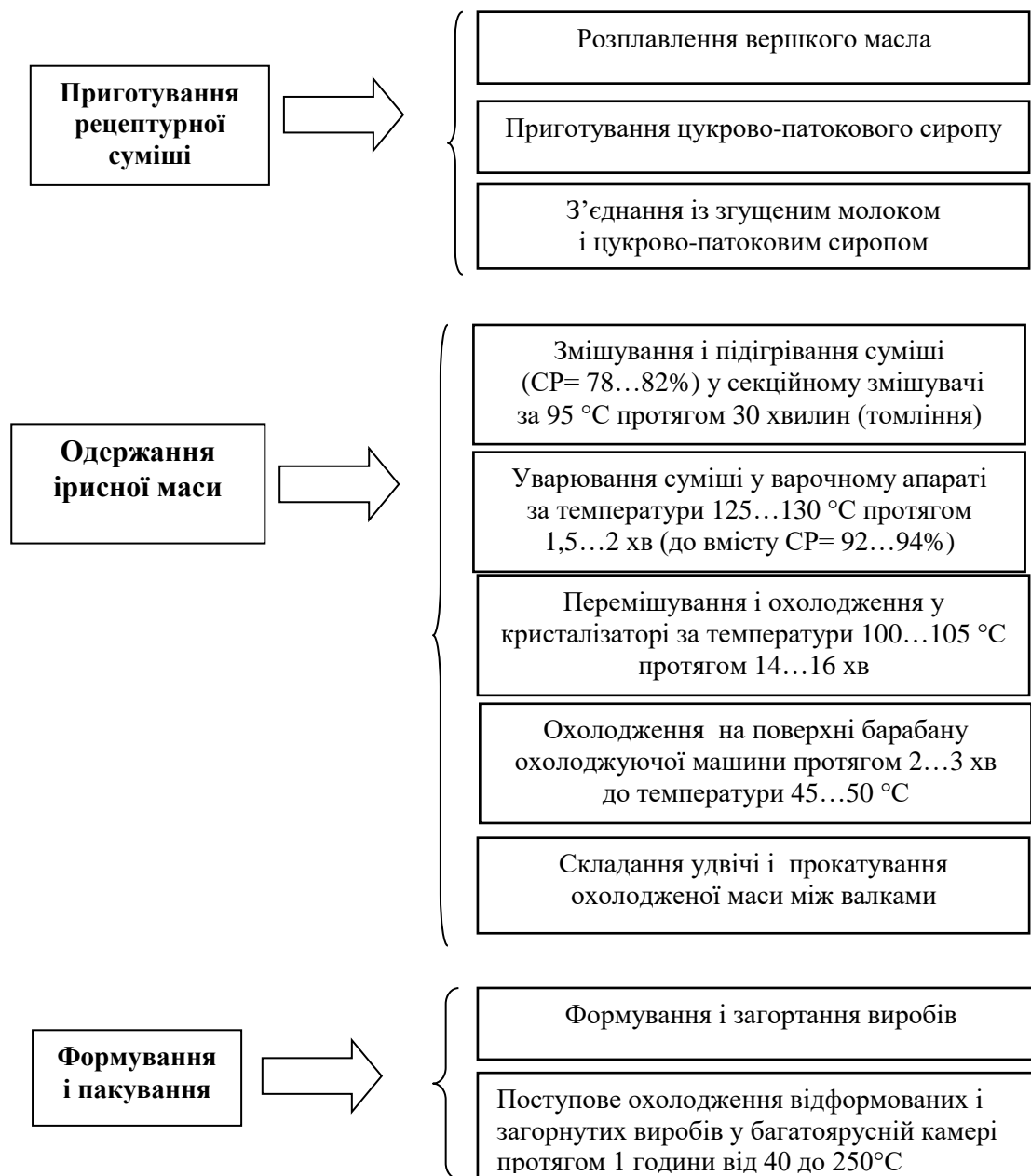
Рис. 5.1. Технологічна схема приготування ірису з кристалічною структурою у вигляді дрібноштучних виробів
