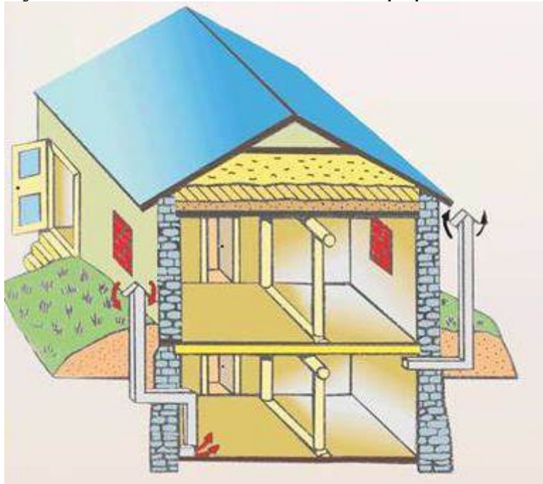
Рис. 9.41. Улаштування системи вентиляції для ПРУ малої місткості
