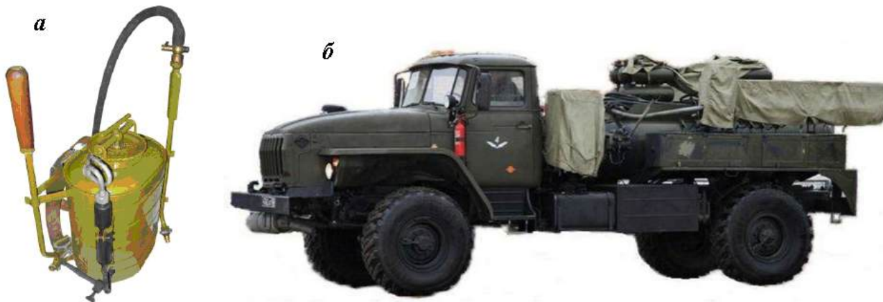
Рис. 10.30. Ранцевий дегазаційний комплект ДК-4 (а); авторозливальна станція АРС (б)
