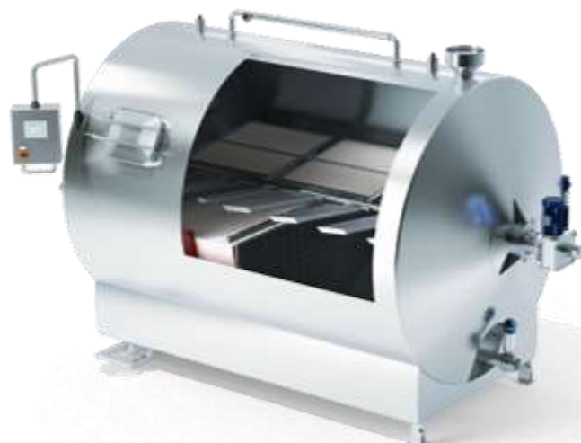
Рис. 8.22. Сировиготовлювач DONI O Vat SC для виробництва м'яких сирів
