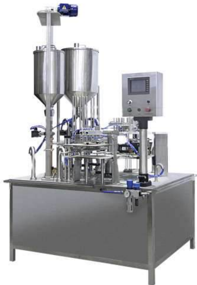
Рис. 4.51. Автомат дворядний для фасування в полістиролові стаканчики
