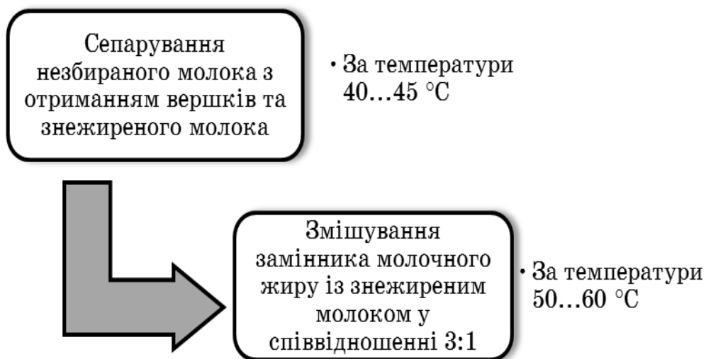
Рис. 8.4. Етапи приготування нормалізованої суміші при виробництві сирів твердих з рослинними жирами
