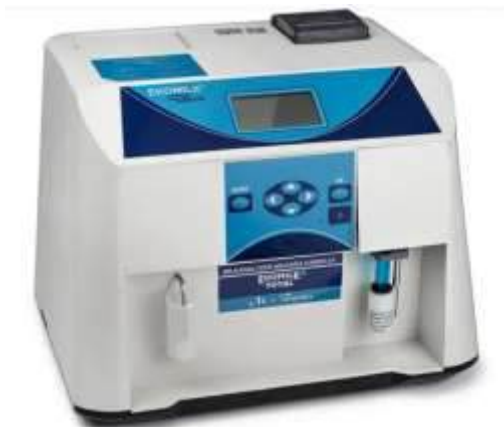
Рис. 2.15. Аналізатор молока ультразвуковий ЕКОМІЛК Bond
