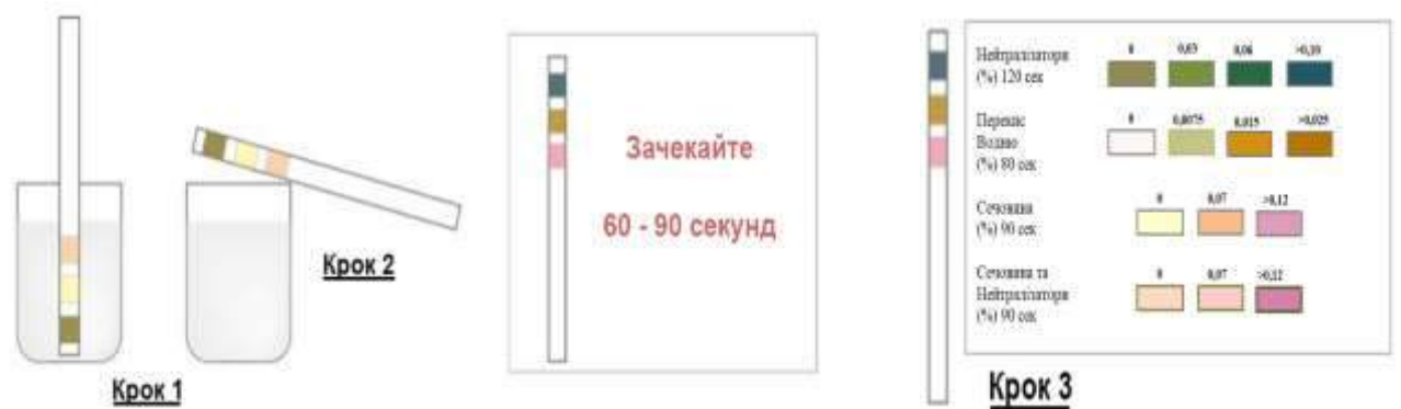
Рис. 2.21. Візуалізація способу застосування тест-смужки Milk Security
