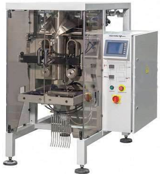
Рис. 5.11. Фасувальний автомат «ПТПАК SMART» для сухих молочних продуктів
