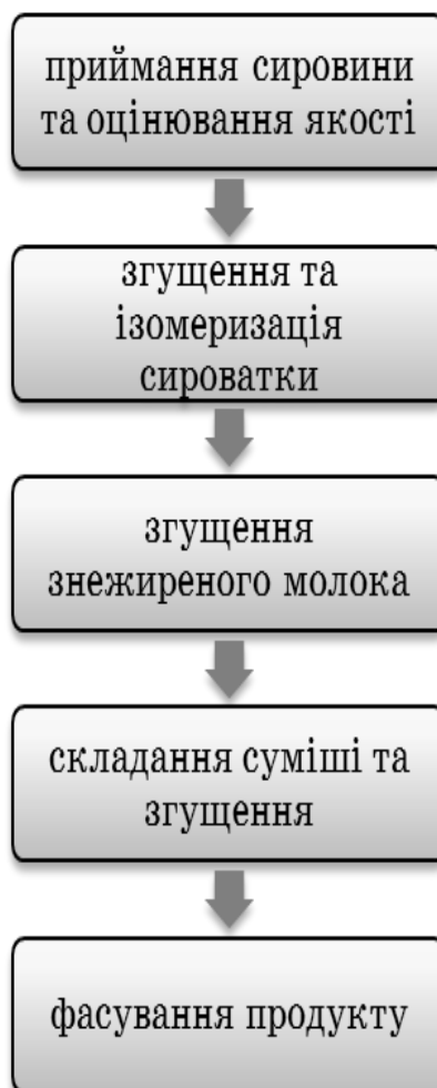
Рис. 5.8. Технологічний процес виробництва блокового продукту
