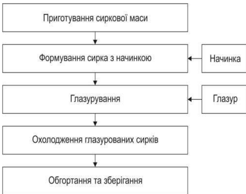
Рис. 4.41. Технологічна схема виробництва глазуrowаних сирків з начинкою
