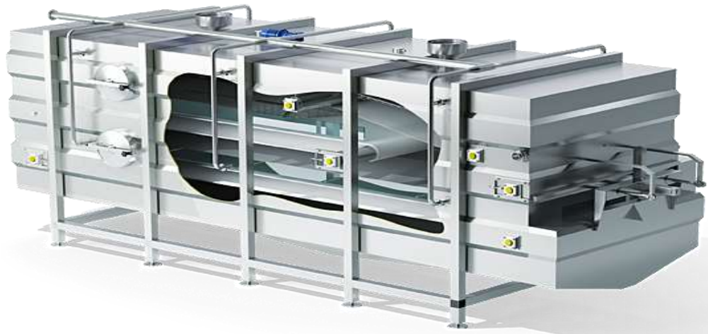
Рис. 8.8. Модуль DONI Cheddarmatic для безперервного відділення сироватки і чеддеризації
