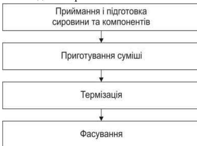
Рис. 4.45. Технологічна схема виробництва термізованих кисломолочних десертів
