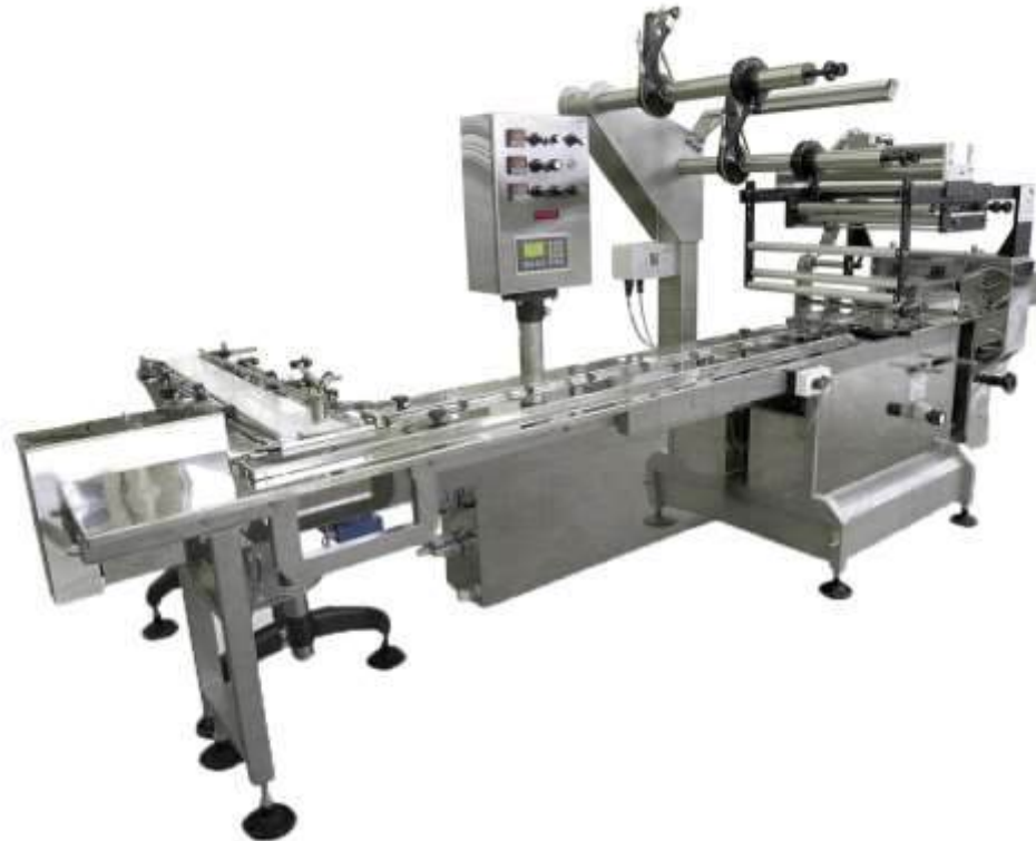
Рис. 4.43. Горизонтальний пакувальний автомат Лінепак ФА в плівку типу Flow-Pack
