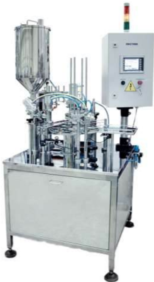
Рис. 4.47. Автомат для фасування в полістиролові стаканчики
