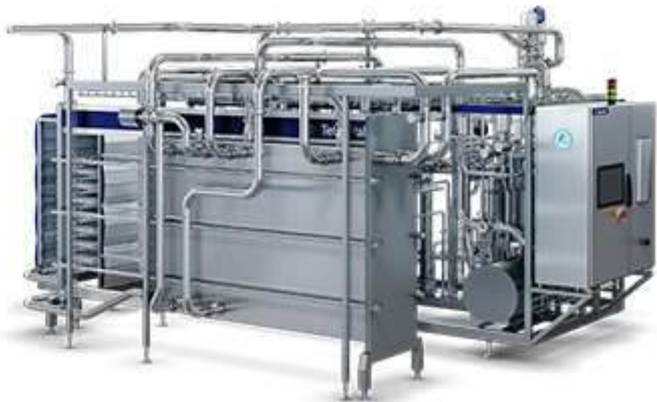
Рис. 2.22. Автоматизована пастеризаційно-охолоджувальна установка Tetra Pak Pasteurizer D
