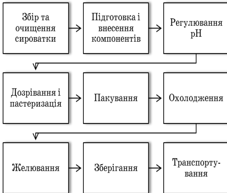
Рис. 9.5. Технологічна схема виробництва структурованих продуктів з молочної сироватки
