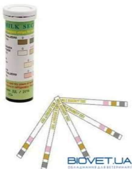
Рис. 2.20. Індикаторні смужки для визначення фальсифікації незбираного (сирого) молока Milk Security
