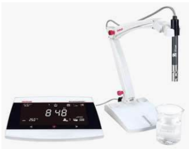
Рис. 2.9. рН-метр ОНАУS серії АQUАSЕАRСHЕR
