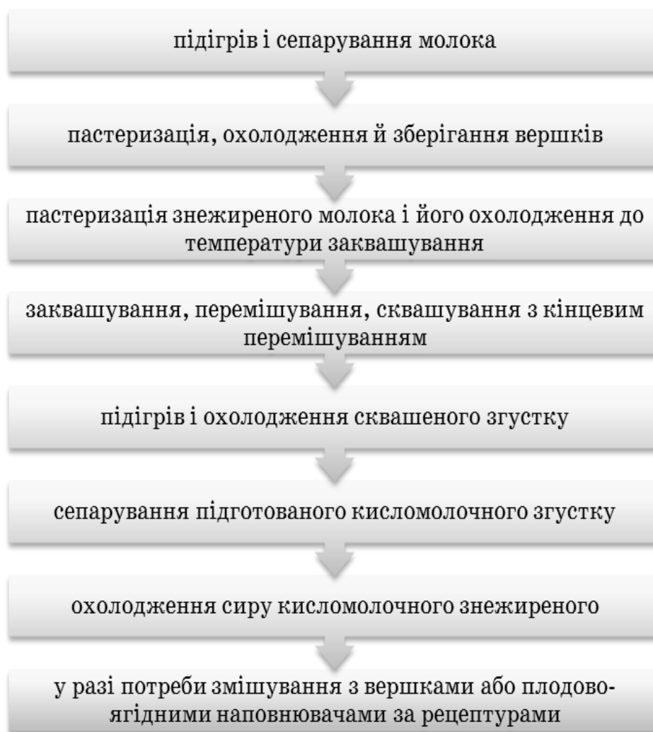
Рис. 4.34. Послідовність технологічних операцій при виробництві сиру кисломолочного м'якого дієтичного
