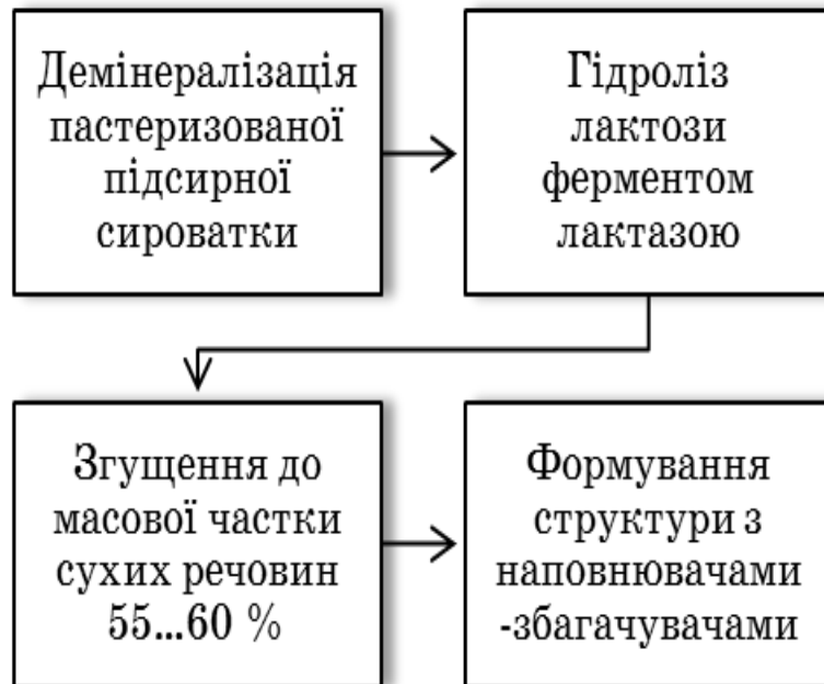
Рис. 9.6. Технологічний процес виробництва сирів м'яких «Лакточіз»
