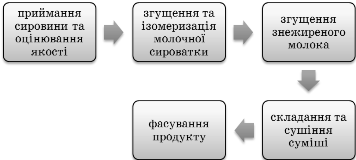
Рис. 5.10. Технологічний процес виробництва сухого комбінованого продукту
