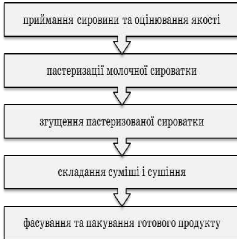
Рис. 5.12. Технологічний процес виробництва яєчно-сироваткових концентратів
