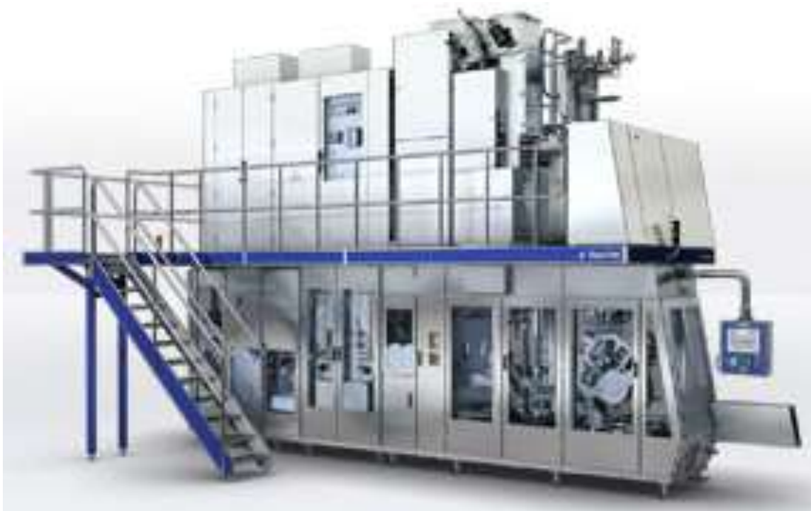
Рис. 4.9. Пакувальний автомат Tetra Pak A3/Flex
