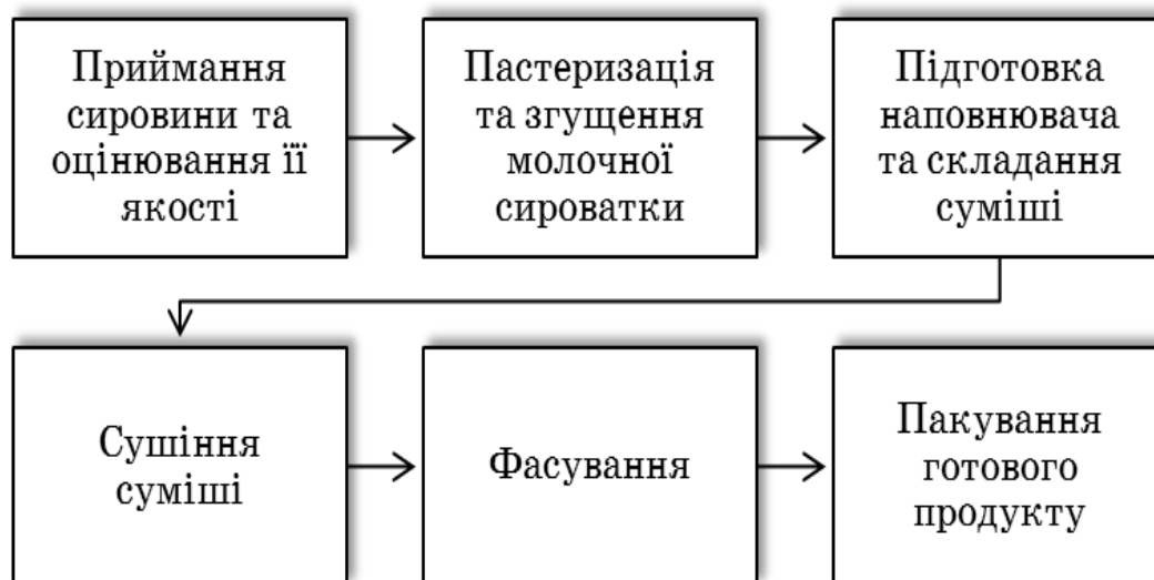
Рис. 5.13. Технологічний процес виробництва сироваткового концентрату–збагачувача
