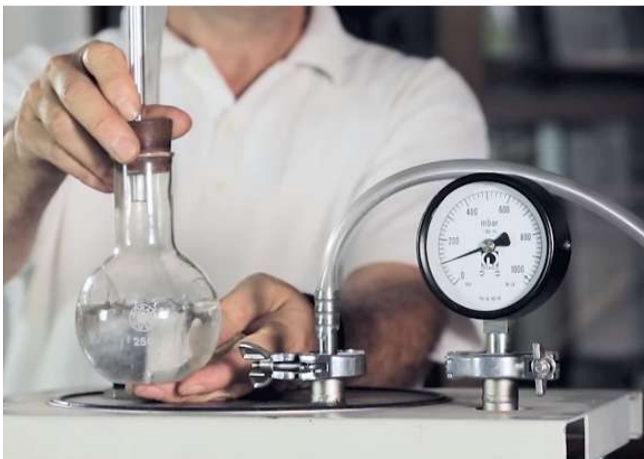
Рис. 8.2. Кипіння води від дотику до руки людини при низькому тискові (~0,098 атм)
