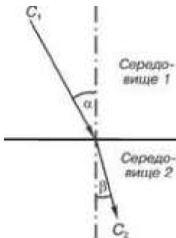
Рис. 3.6. Заломлення світла на межі двох фаз
