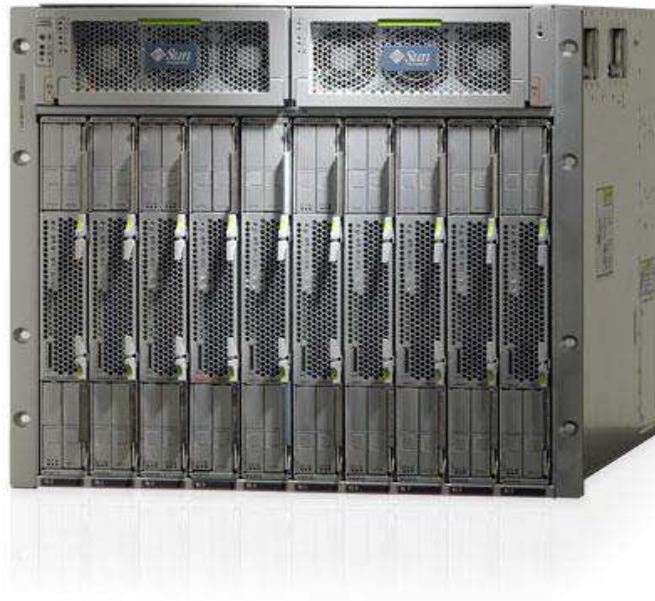
Рисунок 1.2- Типове 10U шасі для 10 Blade-серверів (Sun Blade 6000)
