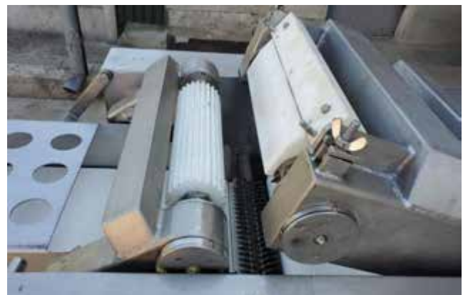
Рис. 14.9. Тендеризатор D-33106 фірми GLASS: а – загальний вигляд; б – робоча камера з підпресовуючим валиком
