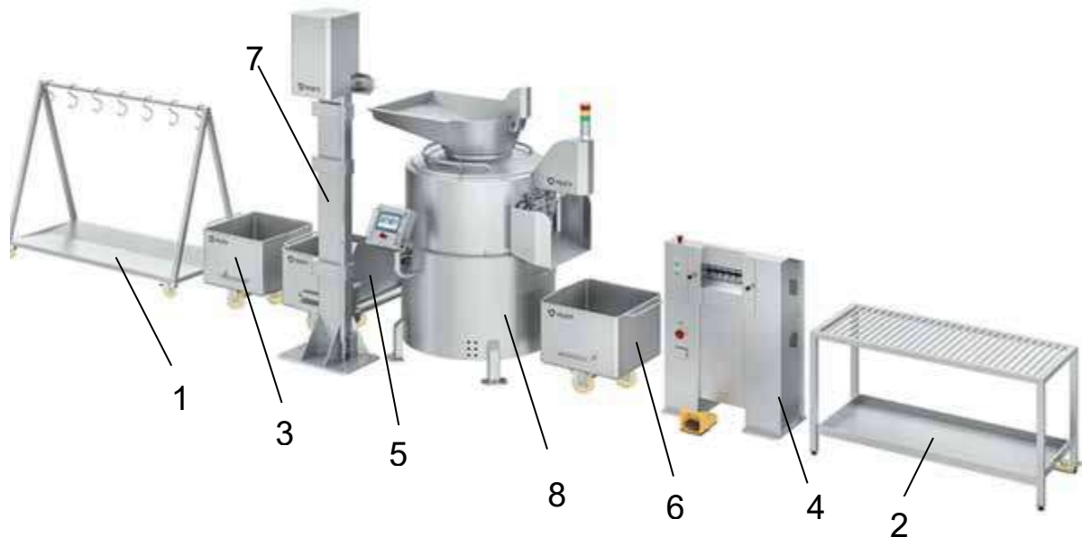
Рис. 21.5. Лінія фірми Feleti для оброблення вовняних субпродуктів: 1 – візок із підвісками; 2 – стіл технологічний; 3,5,6,9 – візки; 4 – машина для знімання копит; 7 – підйомник колонний; 8 – машина відцентрова
