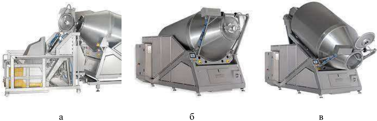
Рис. 14.20. Етапи роботи вакуумного тумблера GPS: а – положення завантаження; б – робоче положення; в – положення вивантаження
