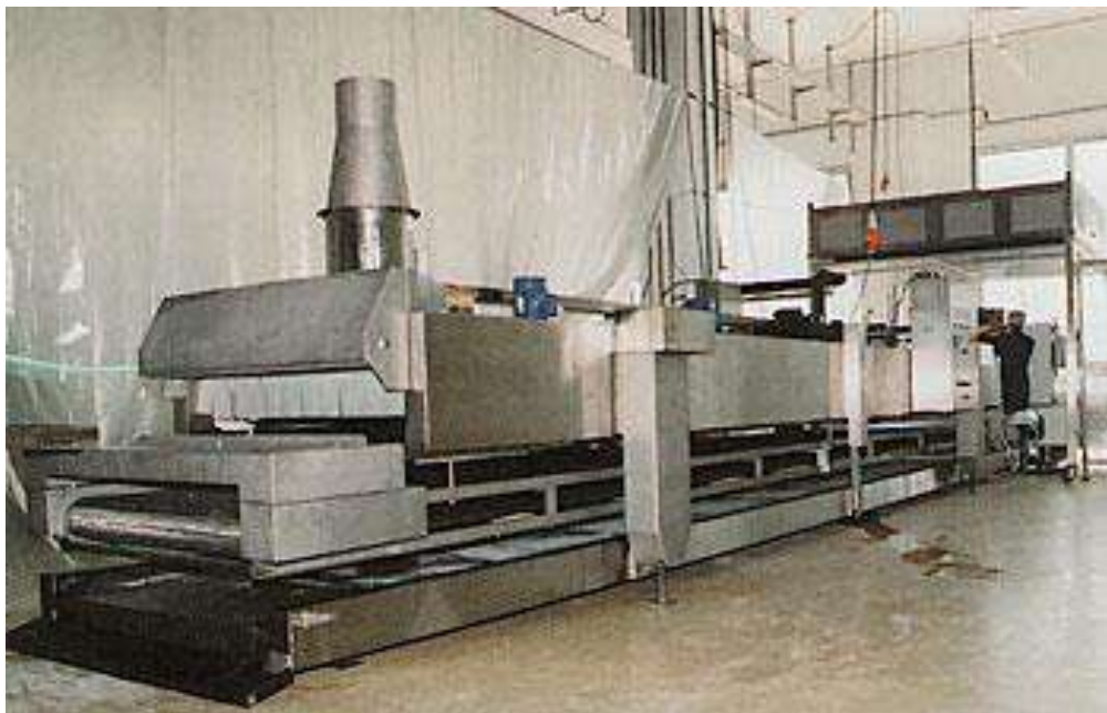
Рис. 19.31. Тунельна кріогенна морозильна установка з горизонтальними конвеєрами: а – схема: 1 – танк для зберігання кріоагенту ; 2 – вхід продуктів; 3 – система подачі рідкого кріоагенту ; 4 – відсмоктування парів агента; 5 – вихід замороженого продукту; б – загальний вигляд
