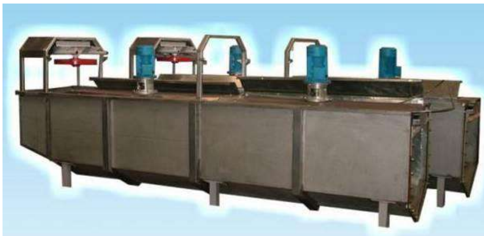
Рис. 13.17. Апарат К7-ФЦЛ-6/5 для ошпарювання птиці з центральним розташуванням насоса: а – схема; б – загальний вигляд
