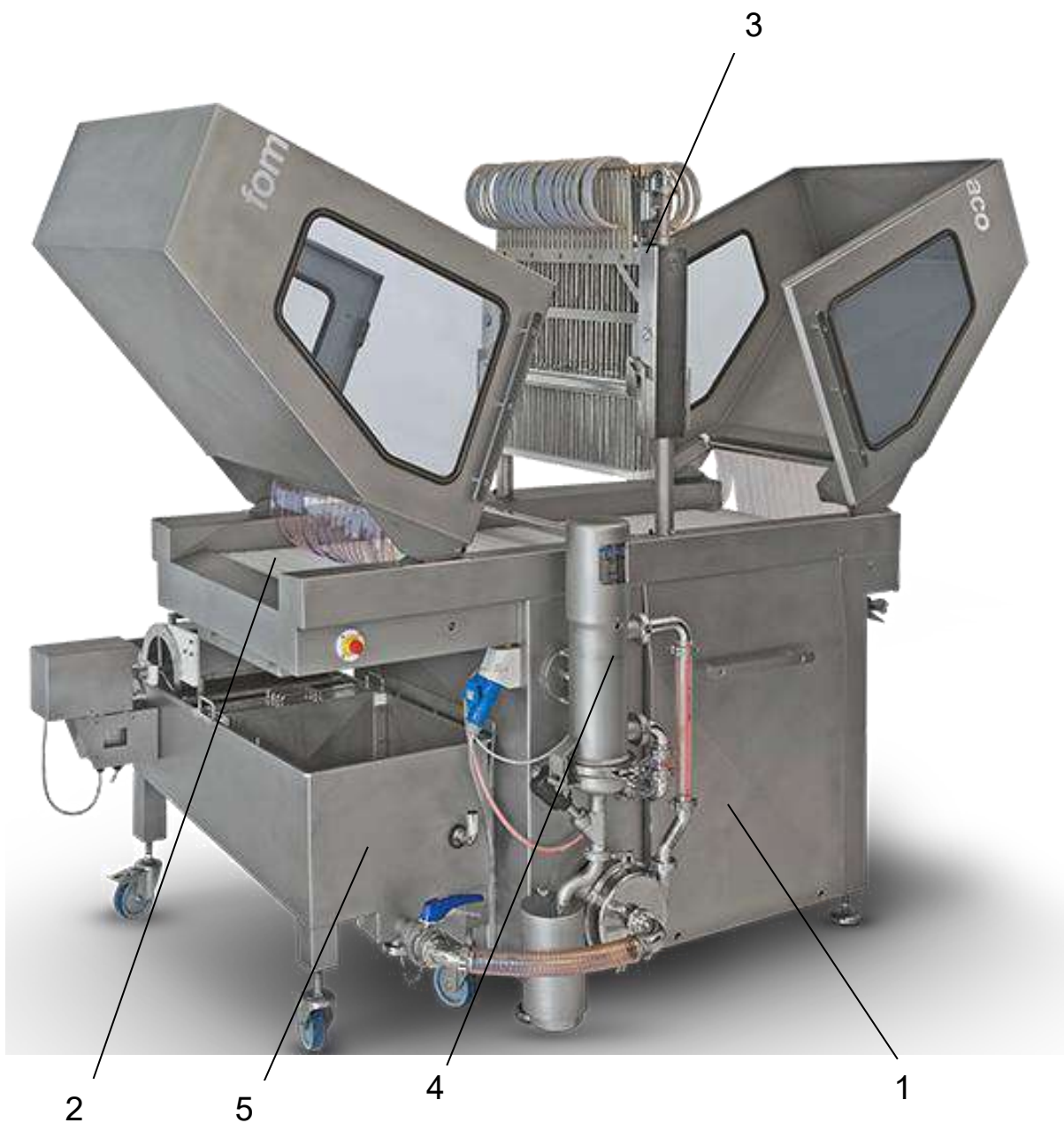
Рис. 14.3. Машина типу FGM фірми «Fomaso Food Machinery» (Данія) для ін'єкційного засолу м'яса
