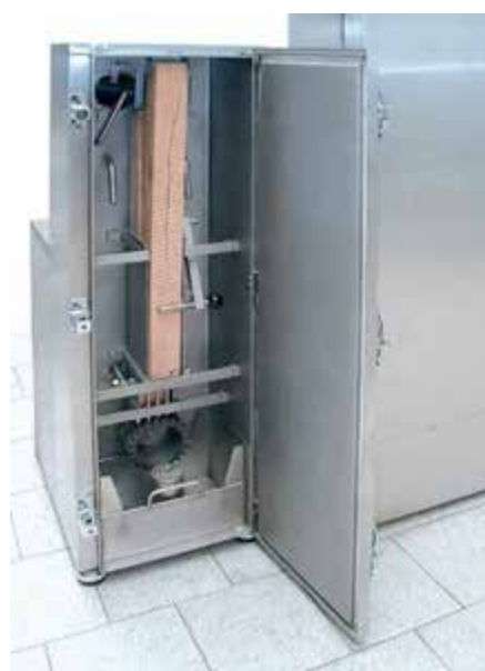
Рис. 15.42. Дисківий фрикційний димогенератор: 1 – корпус; 2 – піддон для золи; 3 – барабан; 4, 12 – патрубки для повітря і диму; 5 – дерев'яний брусок; 6 – вантаж; 7 – лебідка; 8 – ручка; 9 – трос; 10 – електродвигун; 11 – вентилятор; 12 – патрубок для відведення диму; 13 – фільтр
