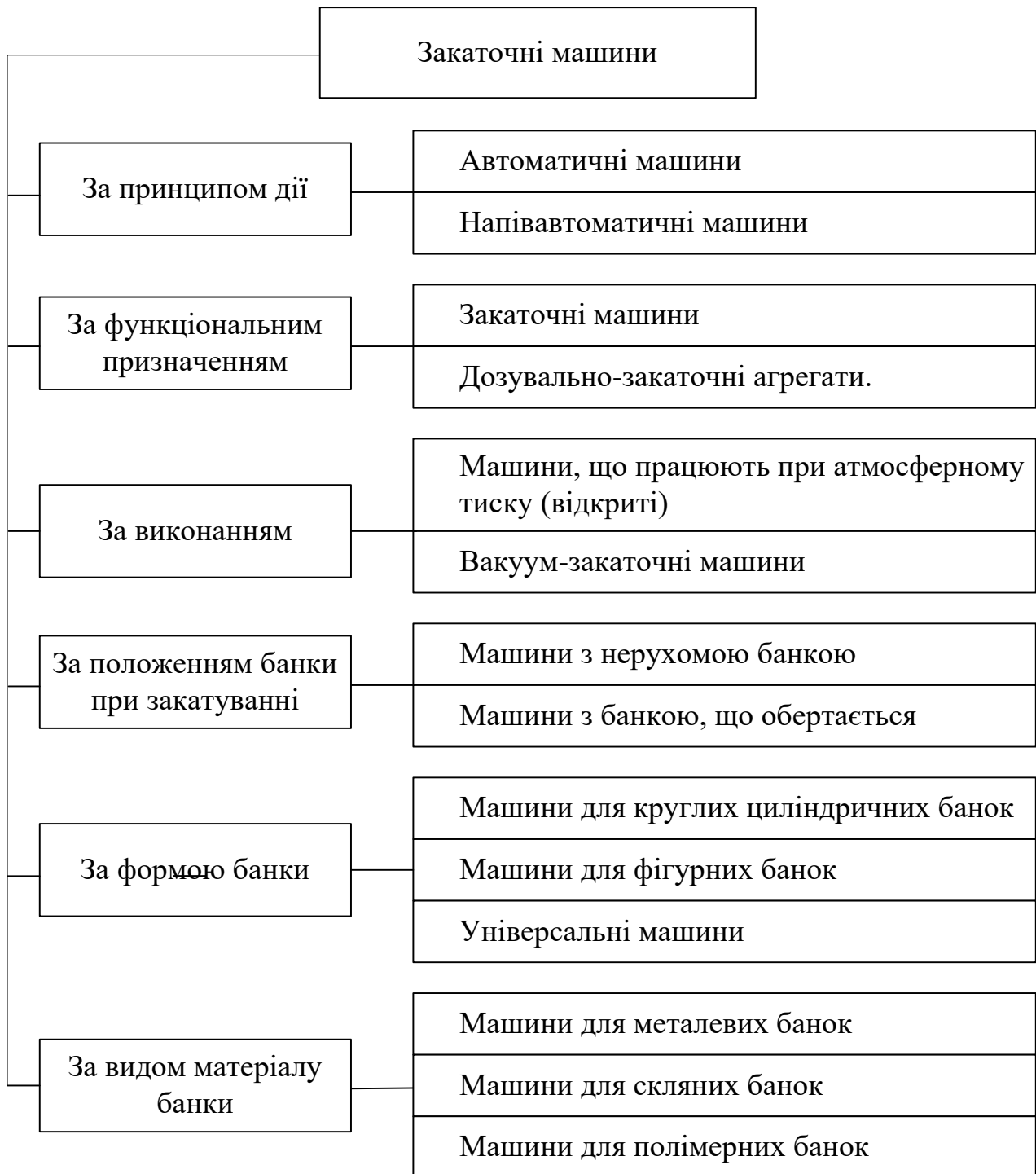
Рис. 22.30. Класифікація закаточних машин
