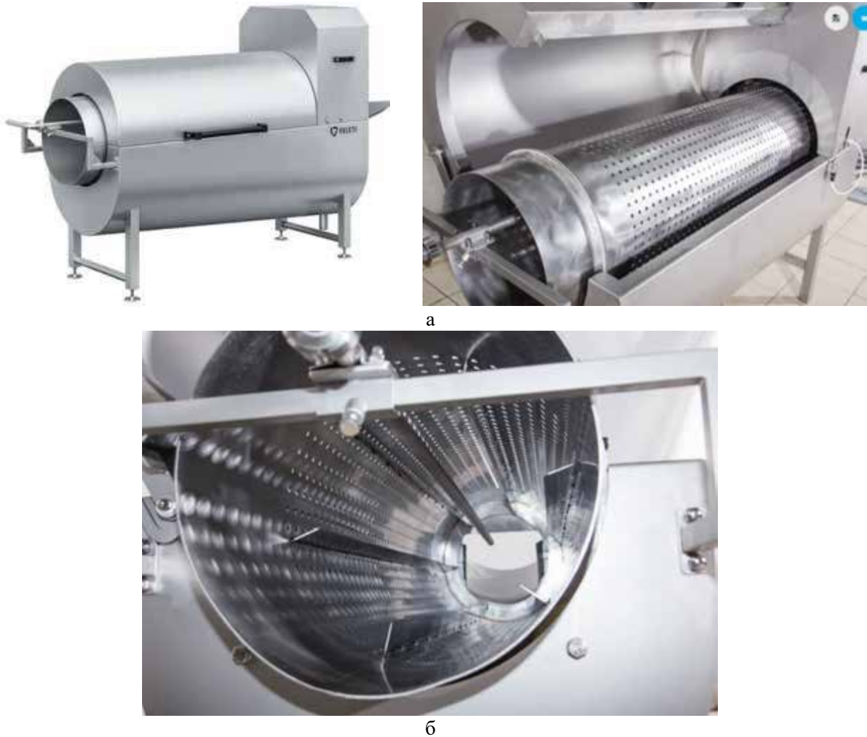
Рис. 21.10. Барабанна мийна машина LF-MD фірми Feleti: а – загальний вигляд; б – робоча камера
