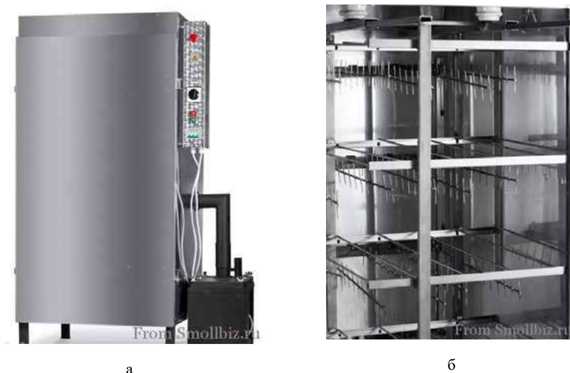
Рис. 15.22. Електрокоптильна шафа «Іжиця»: а – загальний вигляд шафи: б – рама шафи
