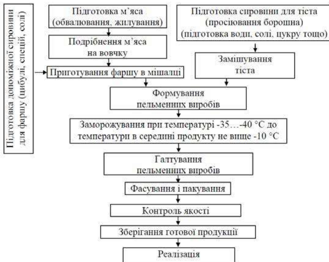
Рис. 26.3. Схема виробництва пельменних виробів
