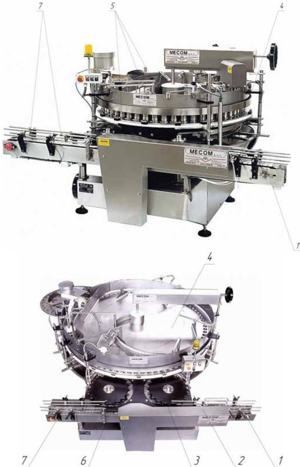
Рис. 22.26. Загальний вигляд сучасної карусельної фасувальної машини з безперервно рухомим операційним ротором моделі RTA фірми MECOM: 1 – приймальний конвеєр; 2 – шнековий живильник; 3 – завантажувальна зірочка; 4 – операційний ротор; 5 – дозатори; 6 – розвантажувальна зірочка; 7 – розвантажувальний конвеєр
