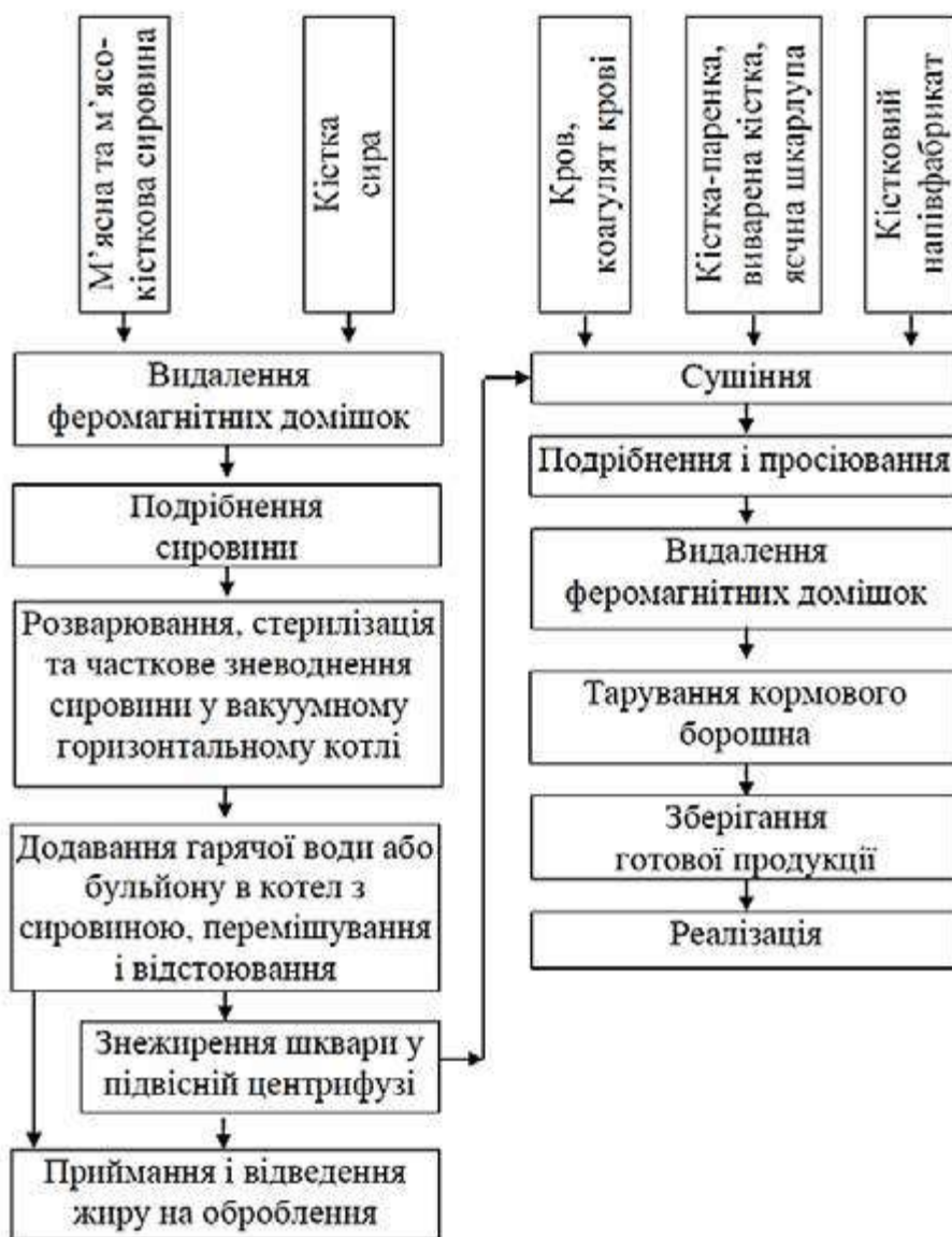
Рис. 27.3. Схема переробки технічної сировини зі знежиренням водою або бульйоном
