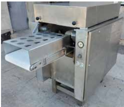
Рис. 14.9. Тендеризатор D-33106 фірми GLASS: а – загальний вигляд; б – робоча камера з підпресовуючим валиком
