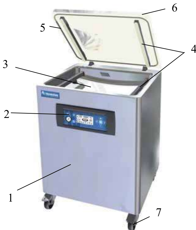
Рис. 22.6. Однокамерна пакувальна машина: 1 – корпус; 2 – пульт управління; 3 – камера; 4 – зварювальні губки; 5 – ущільнювач; 6 – кришка; 7 – колесо
