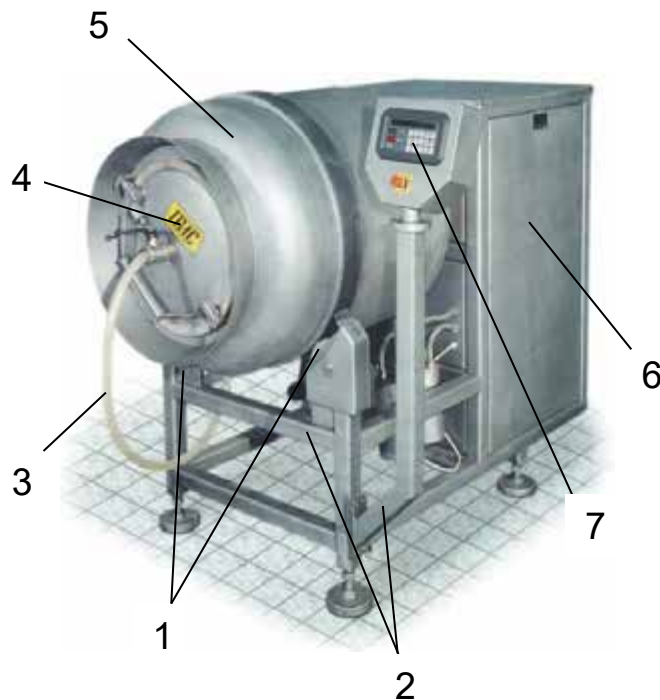
Рис. 14.17. Вакуумний тумблер типу ПМ-ФМВ: 1 – роликова опора; 2 – рама; 3 – вакуумний шланг; 4 – кришка; 5 – барабан; 6 – моторний відсік; 7 – пульт управління
