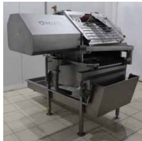
Рис. 20.4. Вальцева машина LF-B фірми Feleti для шлямуння кишок та відтискання
