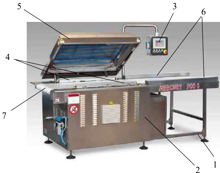
Рис. 22.8. Конвеєрна пакувальна машина: 1 – рама; 2 – корпус, 3 – пульта управління; 4 – зварювальні губки; 5 – кришка; 6 – напрямні; 7 – стрічковий конвеєр
