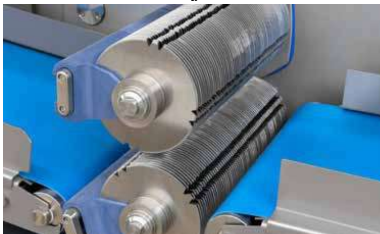
Рис. 14.7. Тендеризатор MultiCarve фірми GEA: а – загальний вигляд; б – робоча камера
