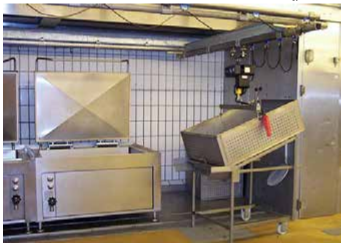
Рис. 15.4. Котел К7-ФВЗ-Е: а – схема; б – загальний вигляд
