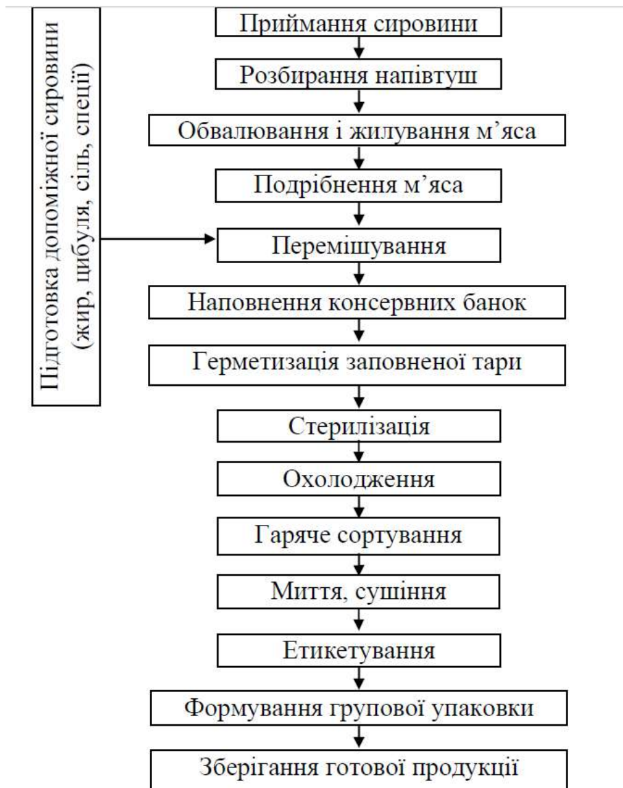
Рис. 25.1. Схема виробництва м'ясних консервів
