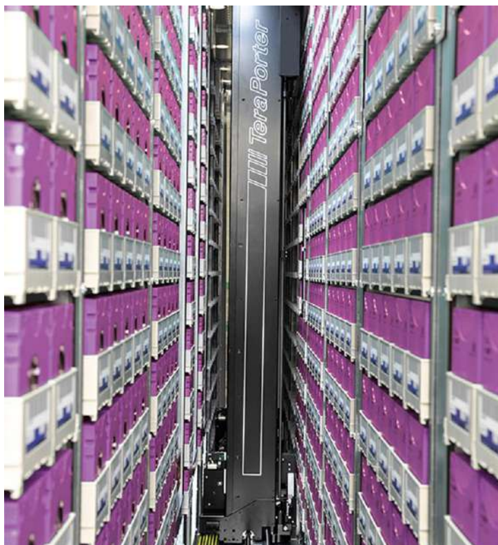
Рисунок 2.4. Завантаження та роботизоване переміщення блоків стрічкових картриджів в стрічковій бібліотеці TFinity
