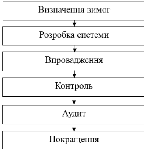
Рисунок 9.8. Блок-схема життєвий цикл системи управління якістю
