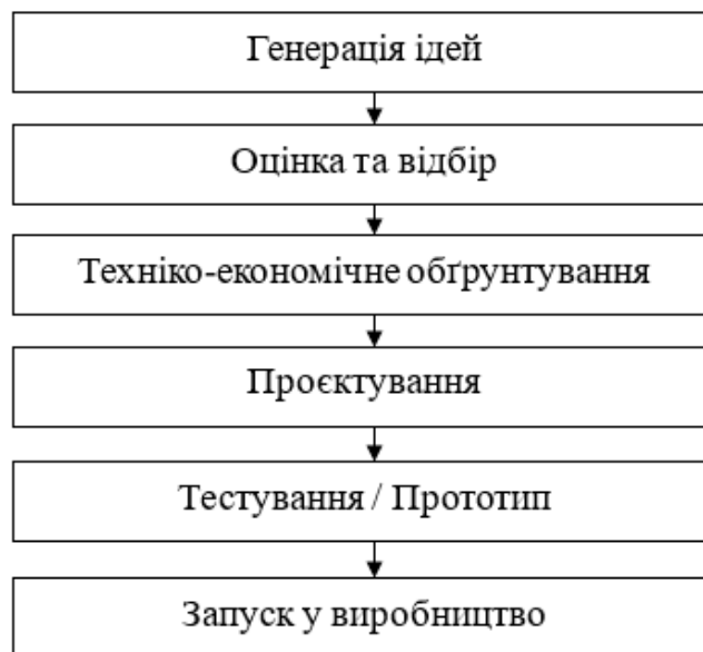
Рисунок 2.8. Блок-схема етапи розробки нового товару або послуги
