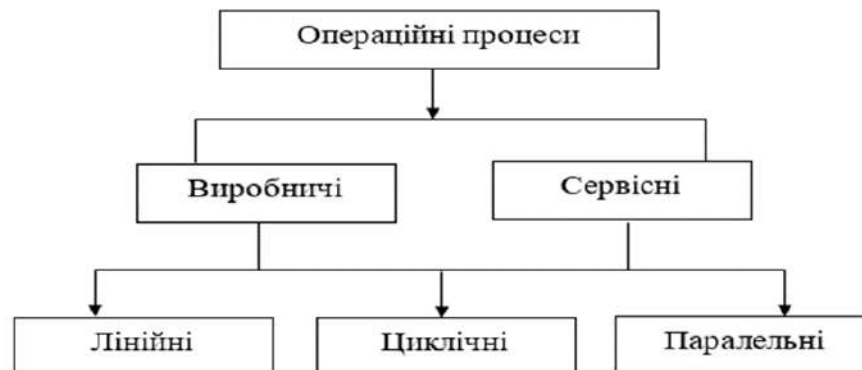
Рисунок 5.5. Блок-схема класифікація операційних процесів
