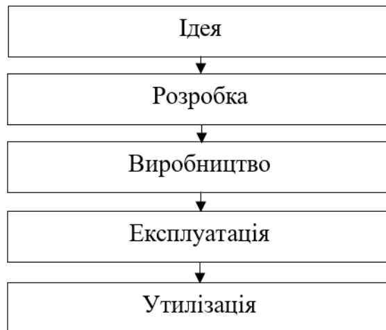
Рисунок 6.5. Блок-схема життєвий цикл виробу
