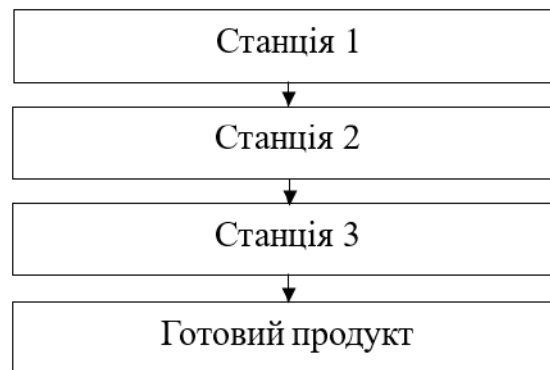
Рисунок 6.8. Блок-схема лінійна організація виробництва
