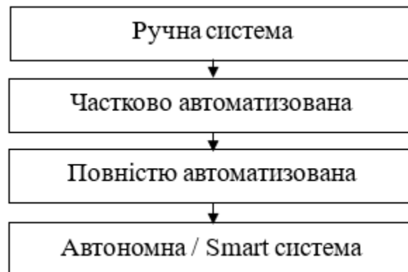
Рисунок 3.8. Блок-схема класифікація за рівнем автоматизації
