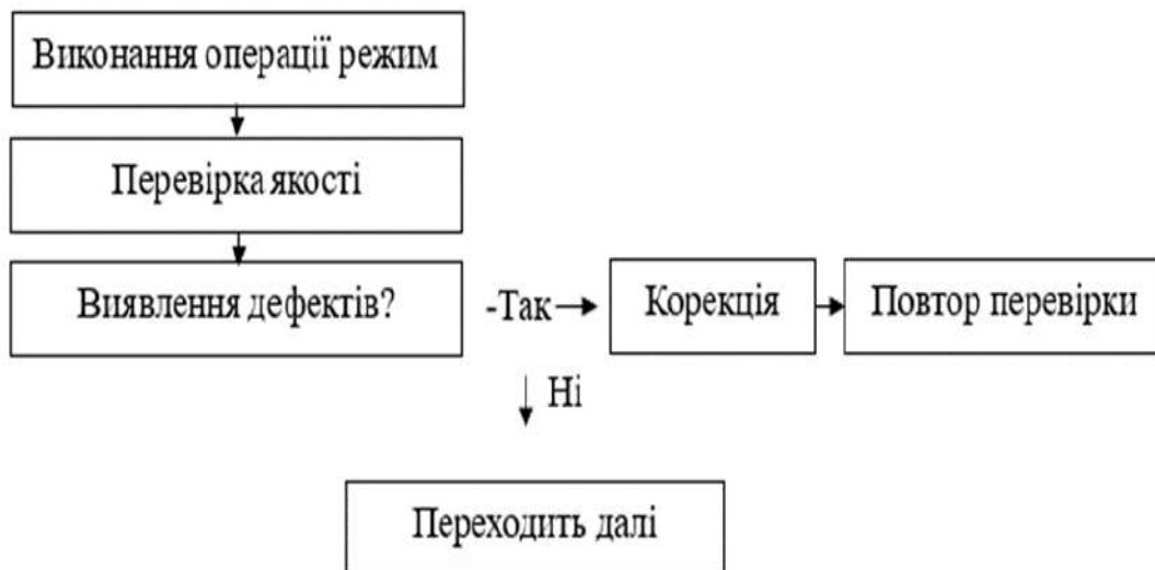
Рисунок 5.2. Блок-схема процес контролю операційного циклу
