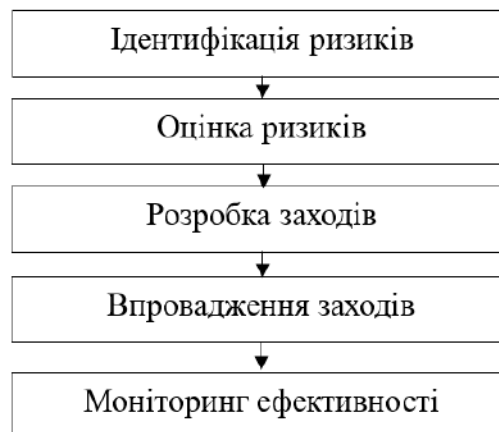
Рисунок 9.2. Блок-схема управління ризиками у якості продукції
