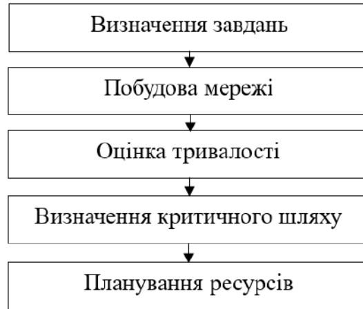
Рисунок 8.9. Блок-схема застосування сіткових методів (CPM, PERT)
