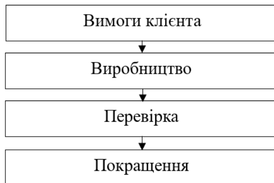
Рисунок 4.8. Блок-схема процес контролю якості (TQM)
