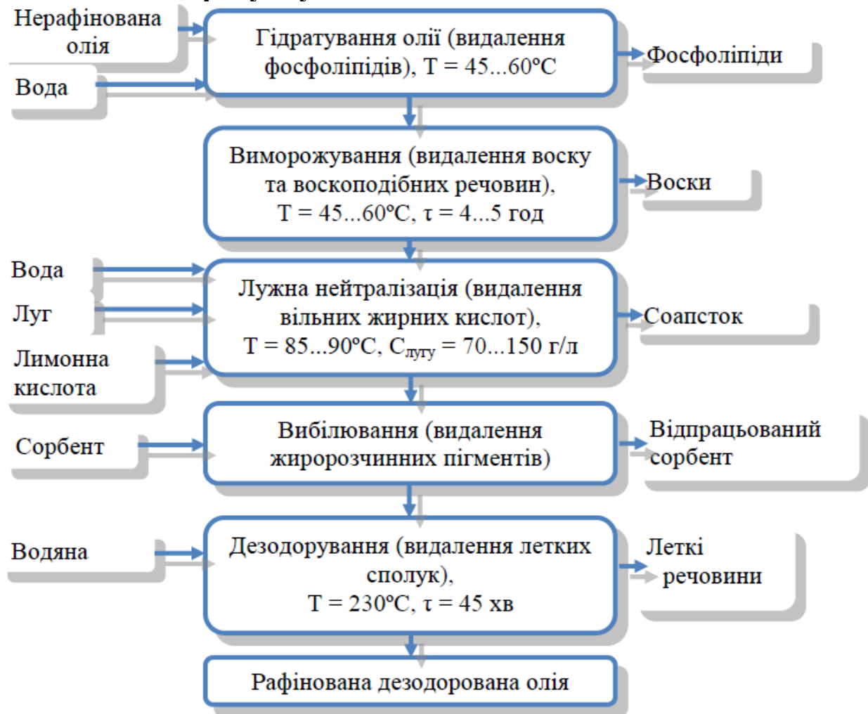
Рисунок 2.15 – Блок-схема повного рафінування олії
