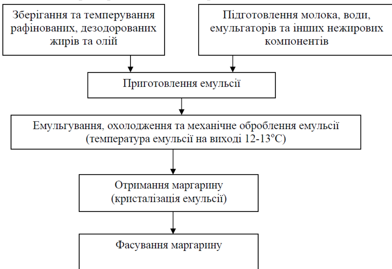
Рисунок 4.2 – Блок-схема одержання маргарину методом переохолодження
