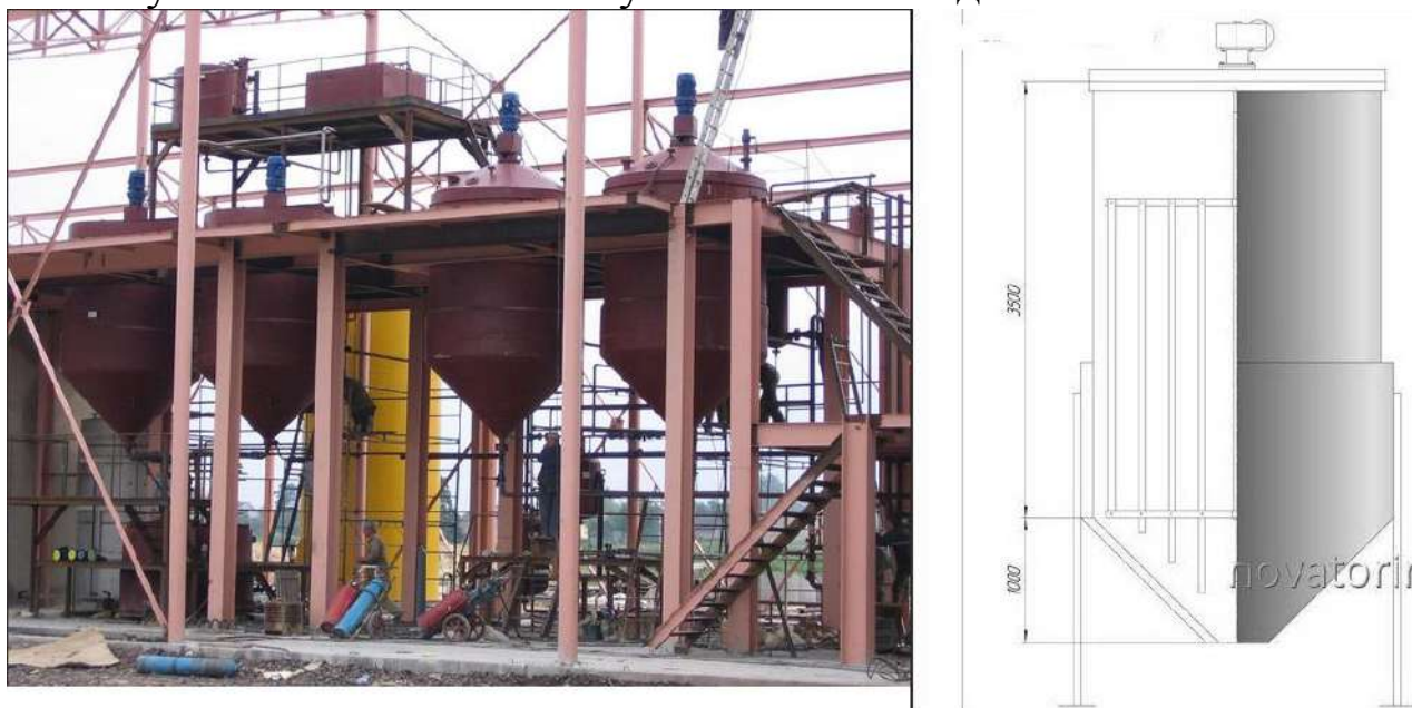
Рисунок 2.16 Зовнішній вигляд та схематичне зображення гідрататора-нейтралізатора
