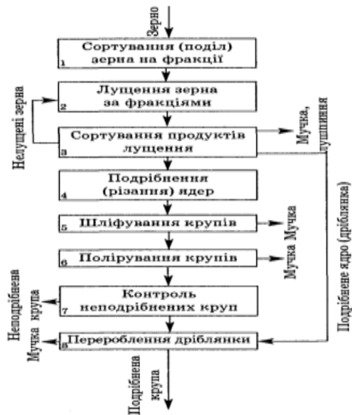
Рисунок 1 — Технологічна схема лущильного відділення крупозаводу
