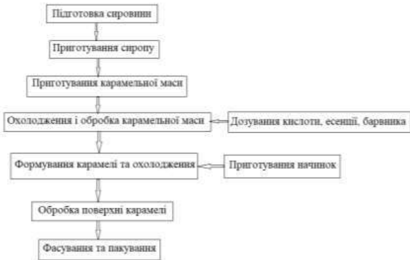
Рис. 5.2. Технологічна схема виробництва карамелі льодяникової
