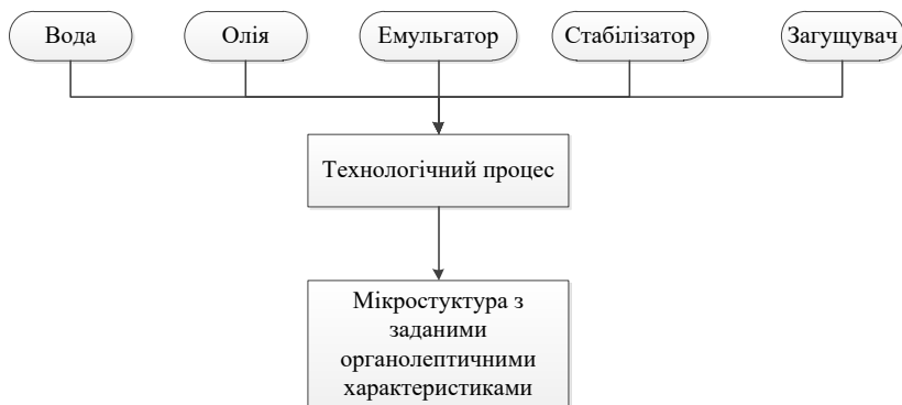
Рис. 3.2. Загальна схема виготовлення майонезу
