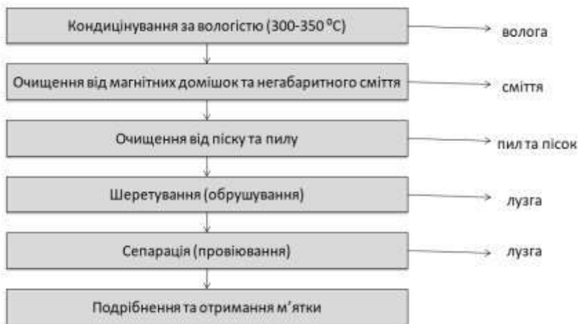
Рис. 1.6. Технологічні етапи отримання м'ятки з олійної сировини
