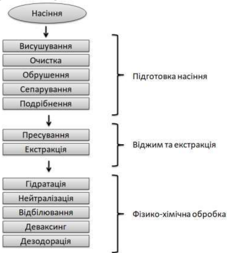
Рис. 1.5. Загальна технологічна схема виробництва соняшникової олії
