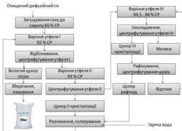
Рис. 4.5. Варіння утфеля та кристалізація цукру
