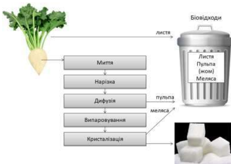
Рис. 4.2. Основні стадії переробки цукрових буряків
