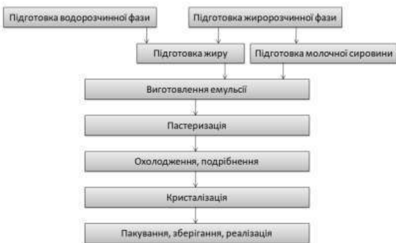
Рис. 2.2. Технологічна схема виробництва маргарину
