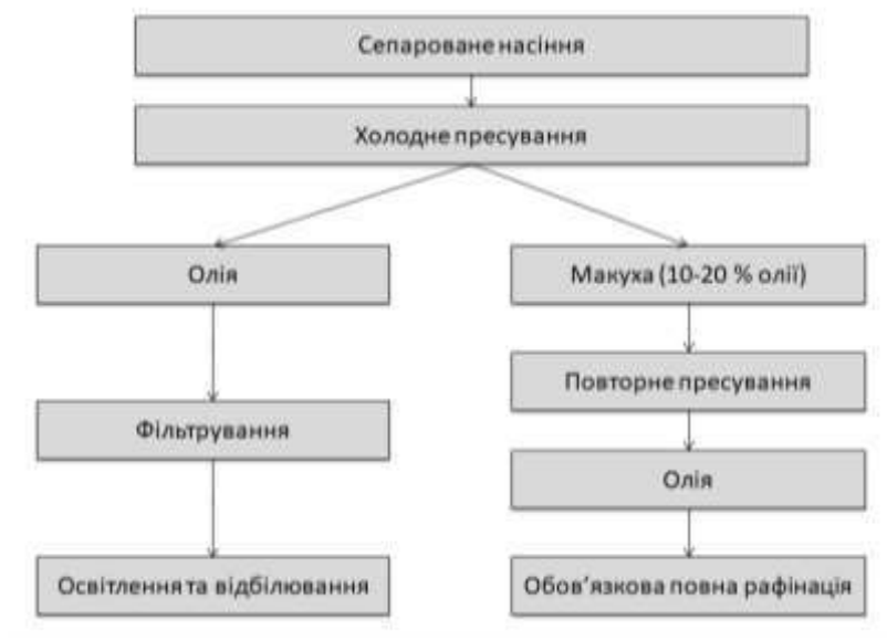
Рис. 1.7. Принципова схема отримання рослинної олії пресуванням
