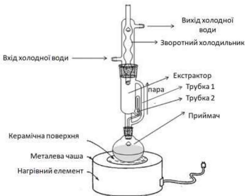
Рис. 4.2. Будова апарату Сокслета.
