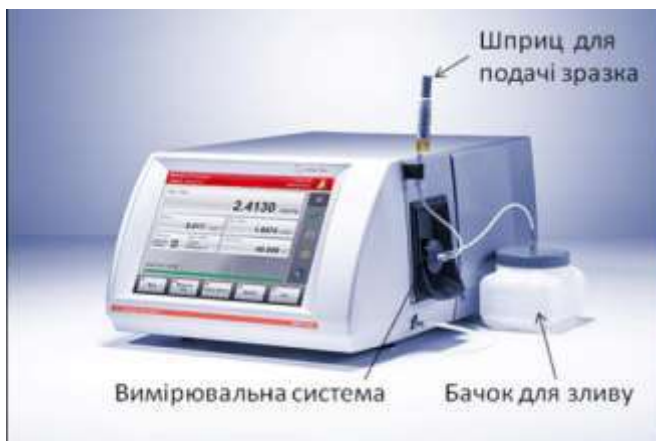
Рис. 4.3. Кінематичний віскозиметр SVM 2001
