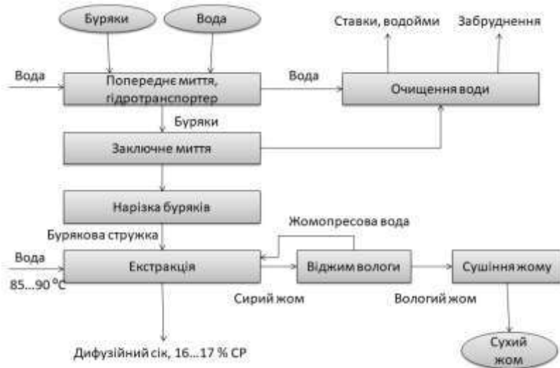
Рис. 4.3. Технологічна схема отримання дифузійного соку
