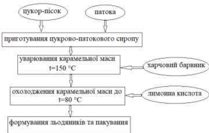
Рис. 5.3. Технологічна схема виготовлення льодяникової карамелі
