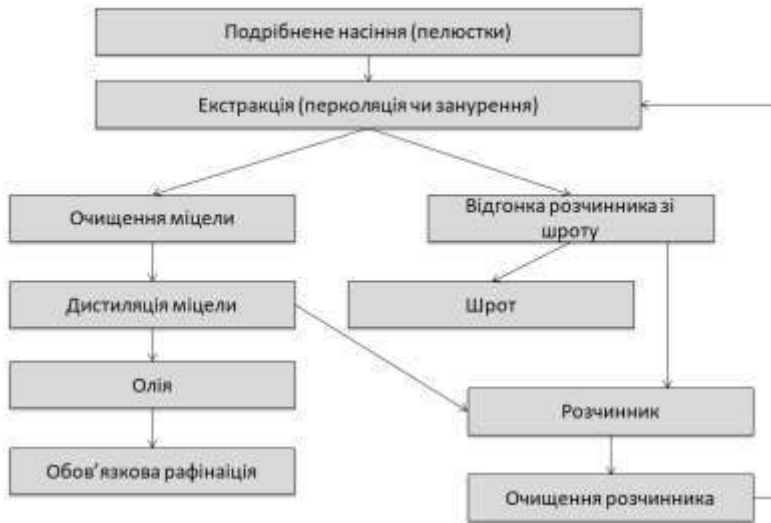
Рис. 1.8. Екстракційне вилучення олії з м'язги або ядра
