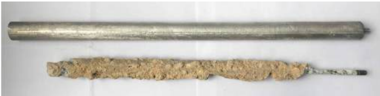
Рисунок 14.7 – Зовнішній вигляд магнієвого анода: нового (зверху) і після п'яти років використання (знизу)
