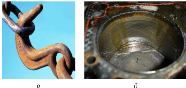
Рисунок 13.2 – Види хімічної корозії: а – газова корозія, б – корозія у неелектролітах
