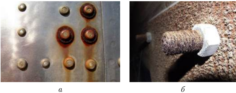
Рисунок 13.1 – Види корозії за характером руйнування: а – місцева корозія, б – загальна (рівномірна) корозія
