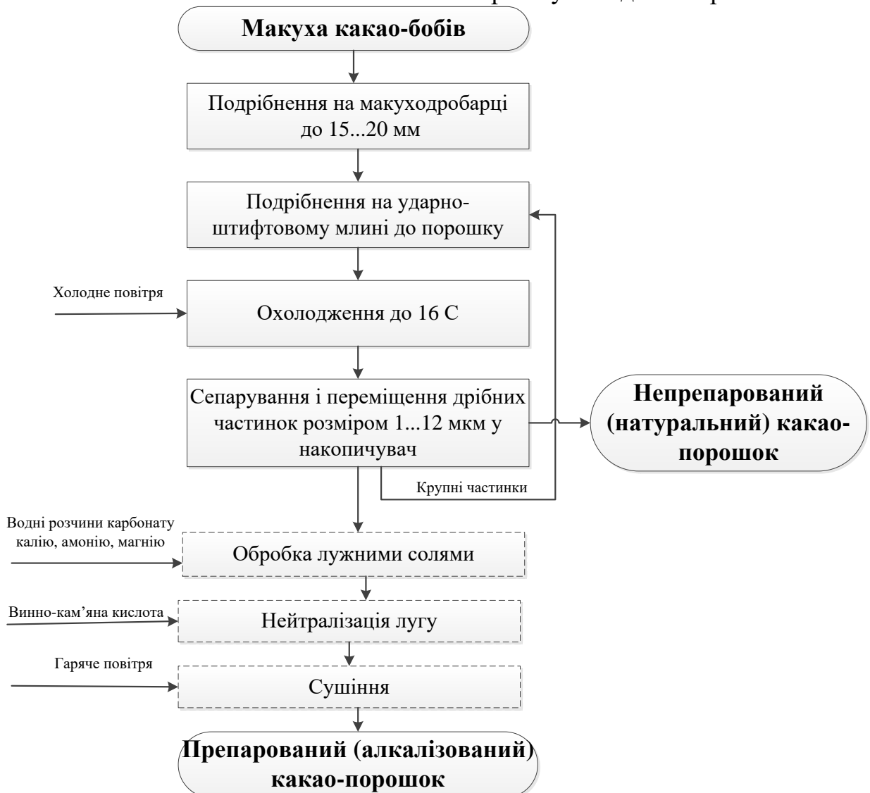
Рис. 4.19. Принципово-технологічна схема виробництва какао-порошку
