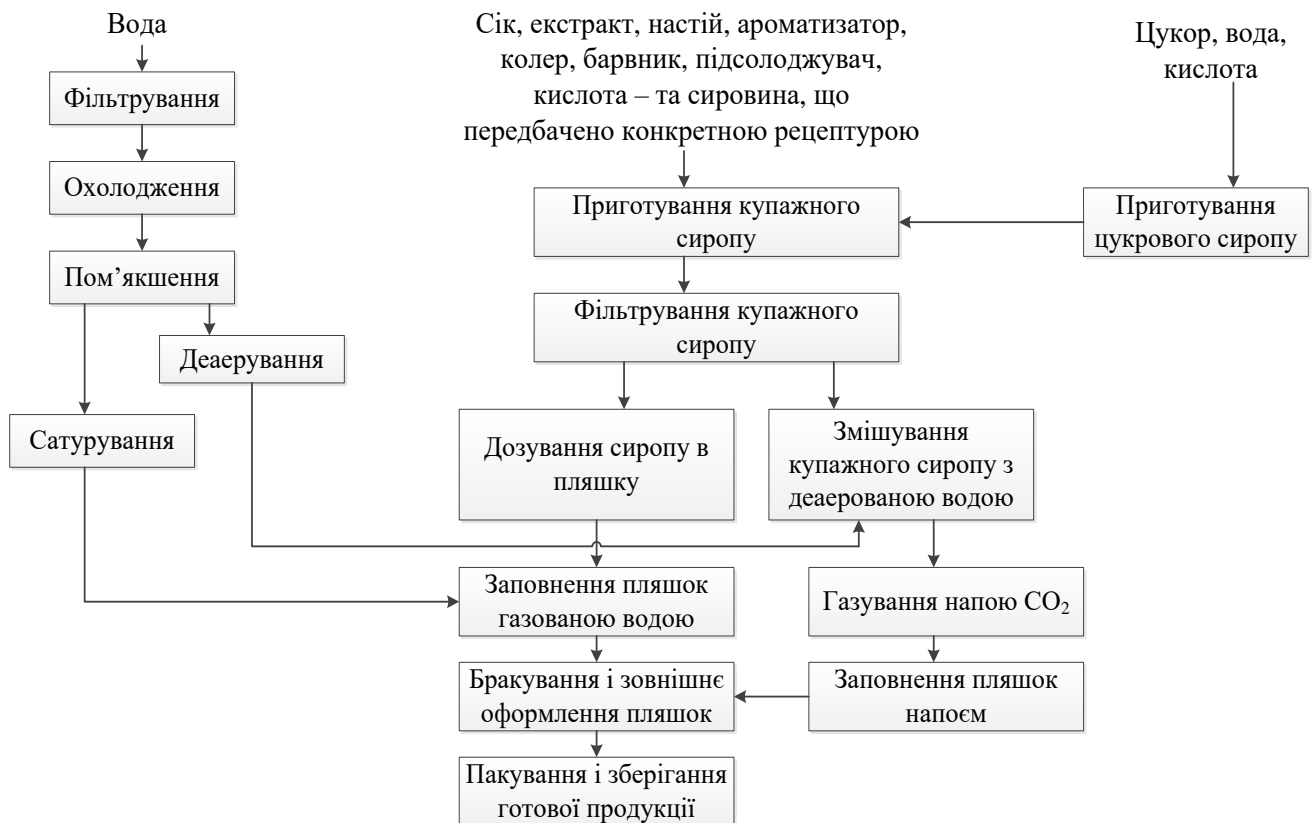
Рис. 3.11. Принципово-технологічна схема виготовлення безалкогольних напоїв купажування
