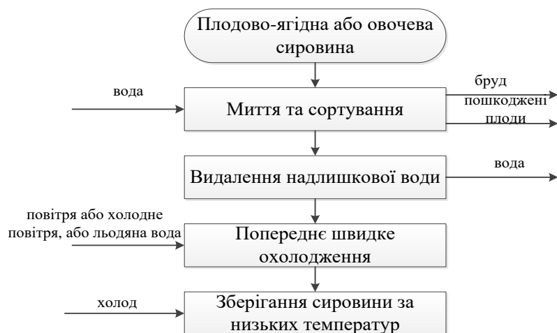
Рис. 1.20. Схема зберігання сировини за допомогою штучного холоду
