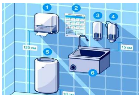
Мал. 3. Рекомендована схема облаштування рукомийника
