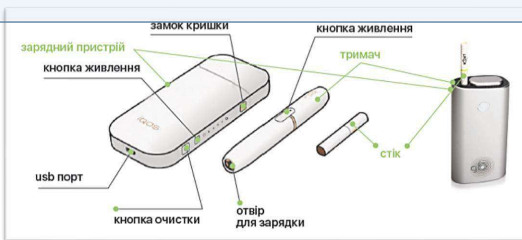
Рис. 2.1.3. Будова системи для нагрівання тютюну IQOS
