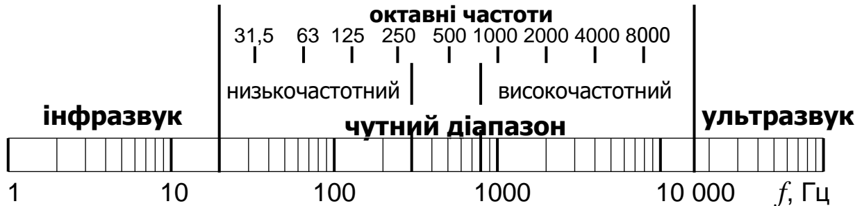
Рис. 6.1 – Розподіл частотного діапазону
