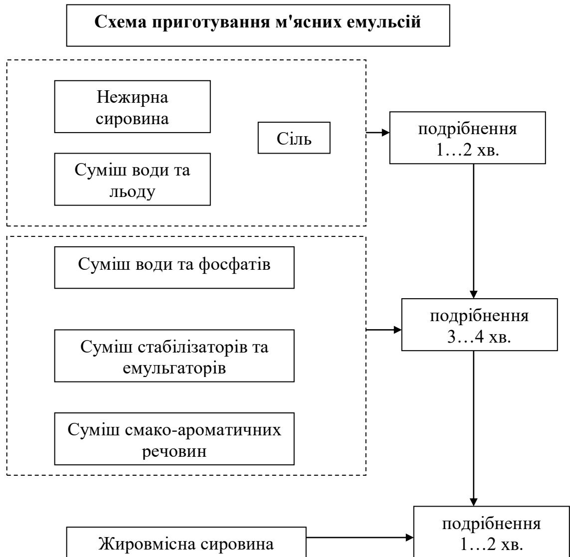
Рис. 1.43 – Схема складання фаршу у кутері
