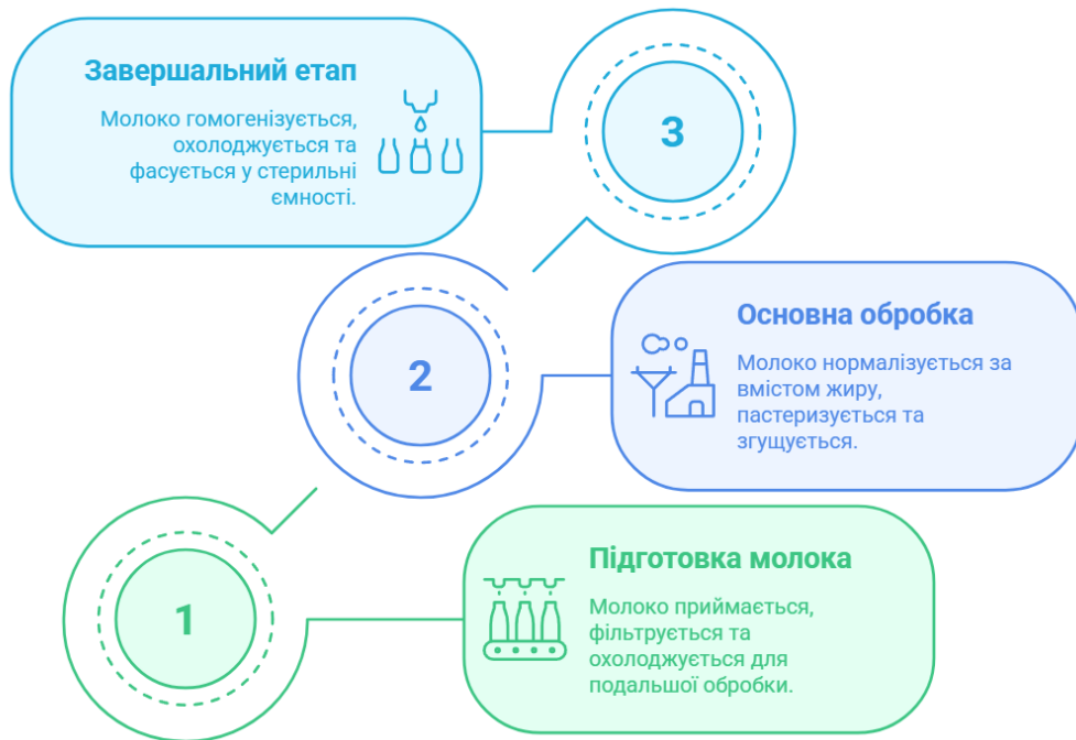
Рис. 2.2 Ієрархічна декомпозиція технологічної схеми (на прикладі виробництва згущеного молока)
